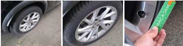
Alloy rim RL, Scratch(es), Repair/replace (lump sum)
