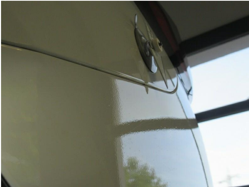
Bild 17 : Nachlackierung Stoßfängerverkleidung hinten links: Oberfläche teils etw. matt, Staubeinschlüsse
