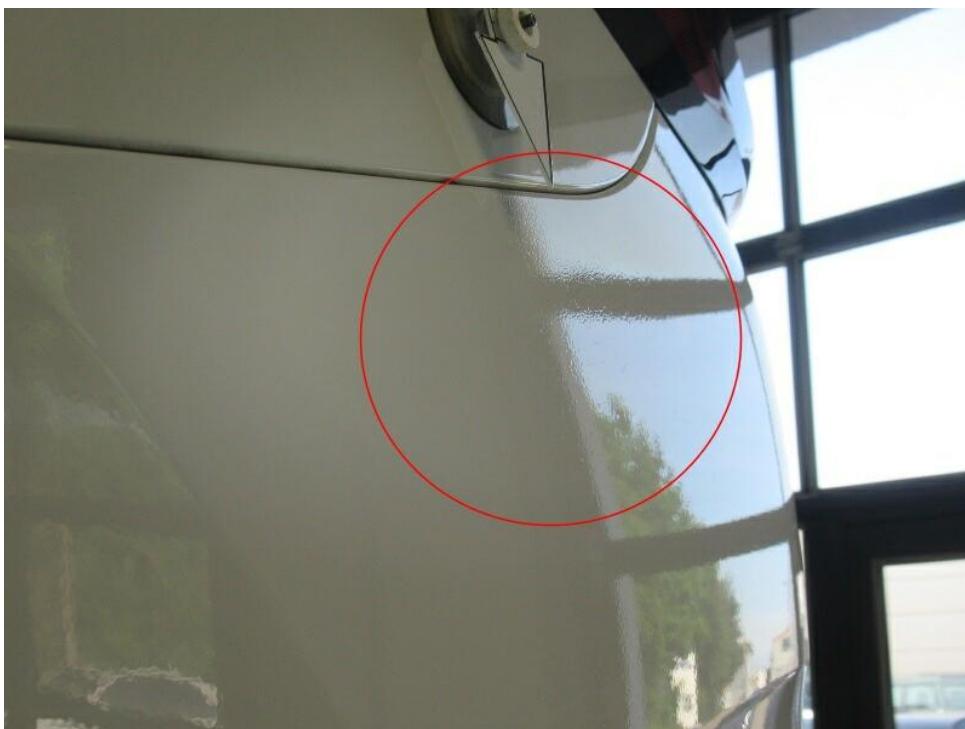
Bild 18 : Nachlackierung Stoßfängerverkleidung hinten links: Oberfläche teils etw. matt, Staubeinschlüsse
