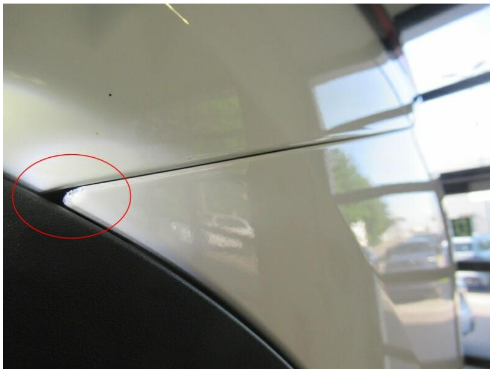
Bild 16 : Nachlackierung Stoßfängerverkleidung hinten links: Kl. Lackabplatzung
