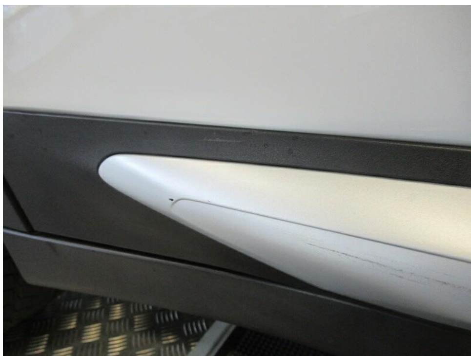
Bild 20 : Tür hinten rechts Schutzleiste unten, zerkratzt, Gebrauchsspur
