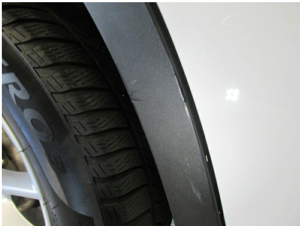
Bild 21 : Seitenteil hinten rechts Zierleiste, zerkratzt, Gebrauchsspur
