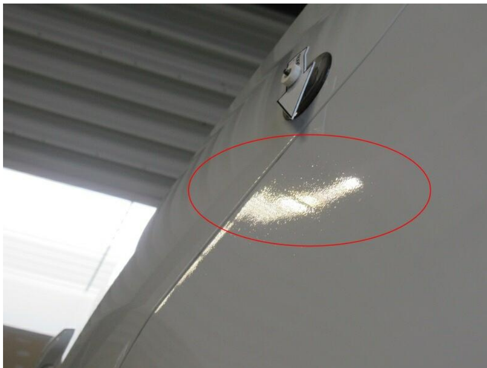
Bild 19 : Nachlackierung Stoßfängerverkleidung hinten links: Oberfläche teils etw. matt, Staubeinschlüsse
