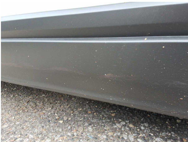
Beschädigung #1: Tür vorn rechts: Tür - Kratzer - instandsetzen
