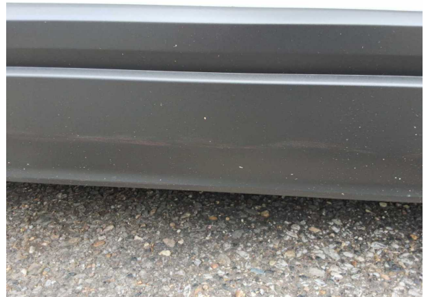
Beschädigung #1: Tür vorn rechts: Tür - Kratzer - instandsetzen
