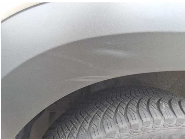
Beschädigung #3: Seitenwand rechts: Radlauf - Kratzer - erneuern
