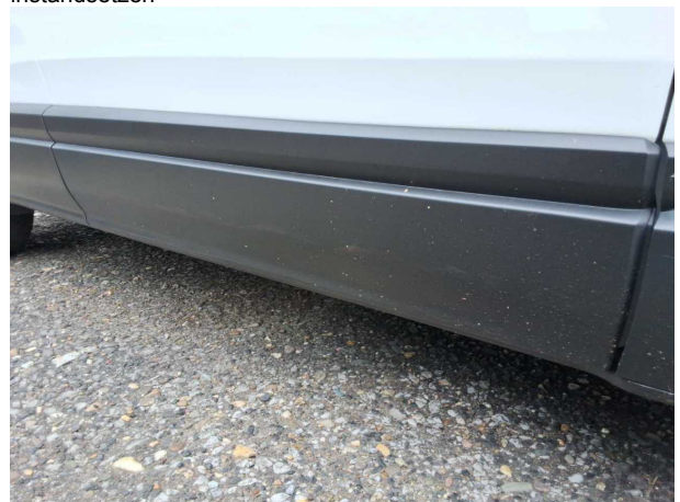
Beschädigung #1: Tür vorn rechts: Tür - Kratzer - instandsetzen
