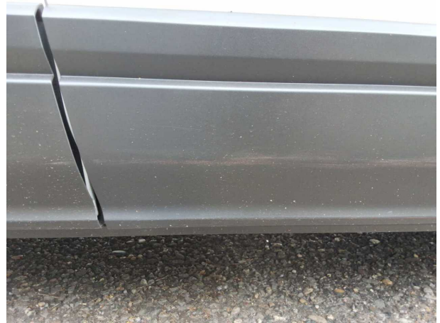
Beschädigung #1: Tür vorn rechts: Tür - Kratzer - instandsetzen
