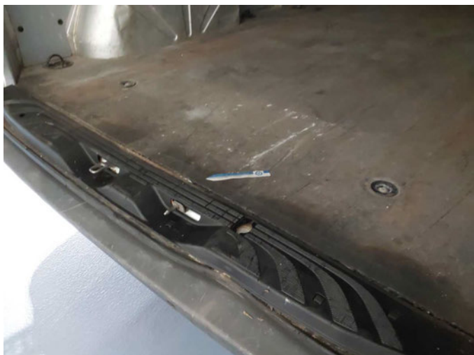
Beschädigung 38: Verkleidungen/Abdeckungen: Verkleidung Ladekante - fehlt - kein Abzug
