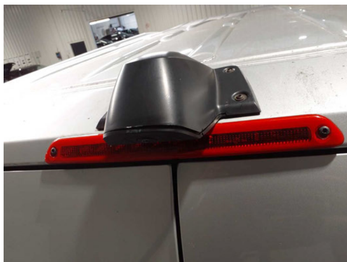
Beschädigung 6: elektronische Systeme: Rückfahrkamera - abweichend Auslieferungszustand - kein Abzug
