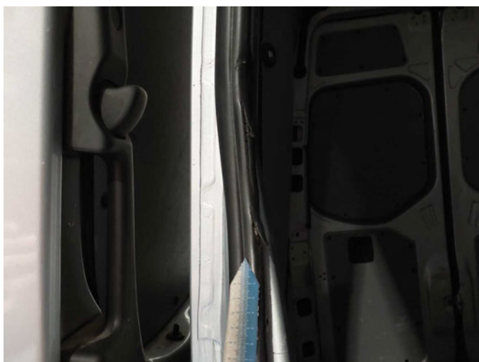
Beschädigung 32: Schiebetür rechts: Türdichtung - Löcher - kein Abzug
