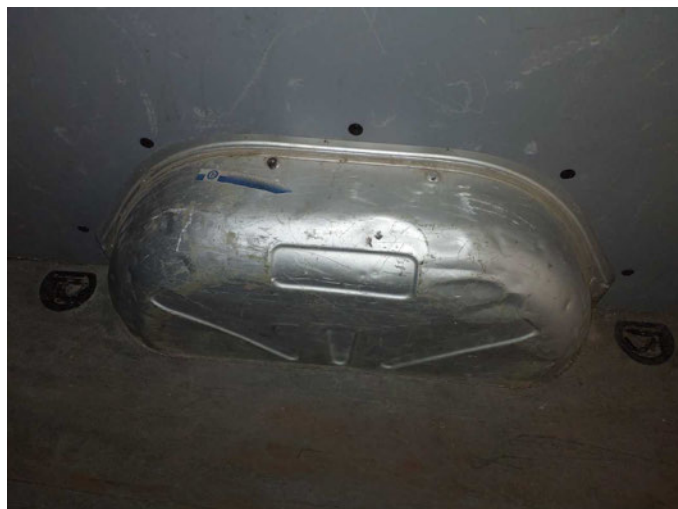
Beschädigung 41: Seitenwand rechts: Radlauf - Delle / Lackschaden - kein Abzug
