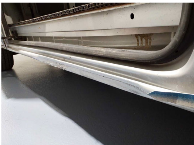
Beschädigung 11: Schweller rechts: Schweller - Delle / Lackschaden - kein Abzug
