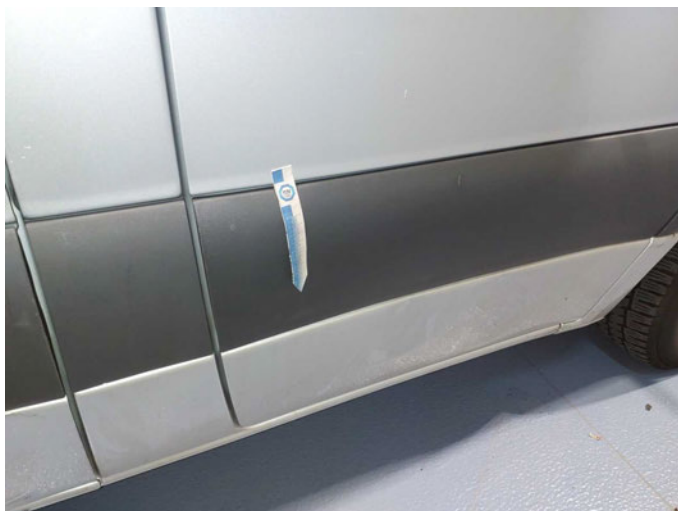
Beschädigung 30: Tür vorn rechts: Zierleiste unten - verkratzt / verschürft - kein Abzug
