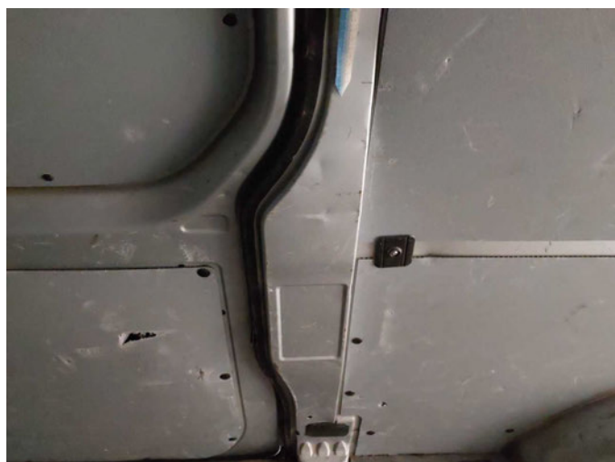
Beschädigung 42: Verkleidungen/Abdeckungen: C-Säule rechts Verkleidung innen - Delle / Lackschaden - kein Abzug
