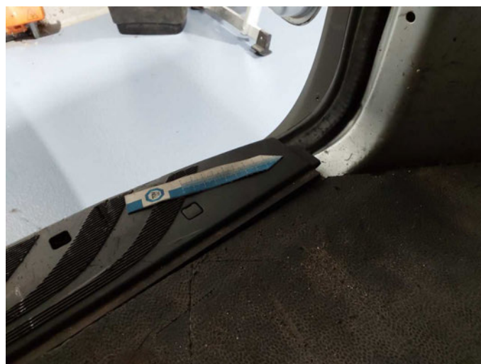
Beschädigung 37: Verkleidungen/Abdeckungen: Verkleidungen/Abdeckungen - Fehlstellung - kein Abzug
