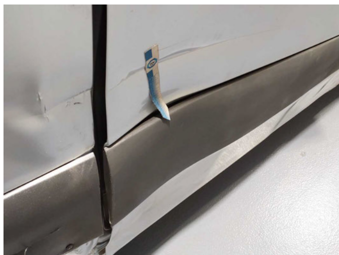
Beschädigung 29: Schiebetür rechts: Zierleiste - Delle(n) - kein Abzug
