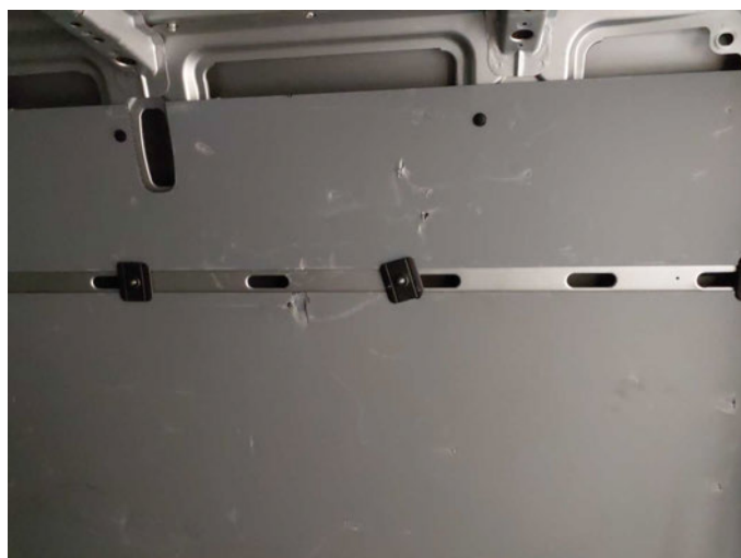
Beschädigung 50: Seitenwand rechts: Innenverkleidung - Löcher - kein Abzug
