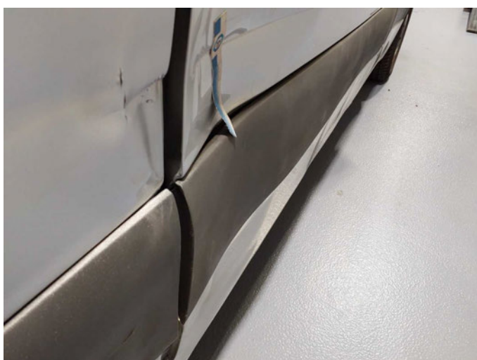
Beschädigung 29: Schiebetür rechts: Zierleiste - Delle(n) - kein Abzug
