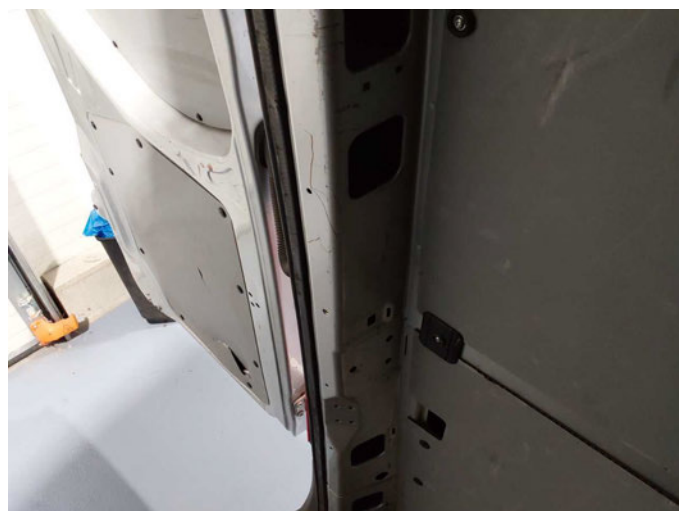
Gebrauchsspur 3: Verkleidungen/Abdeckungen: D-Säule links Verkleidung innen - verkratzt / verschürft - kein Abzug
