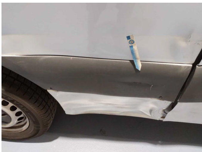
Beschädigung 28: Seitenwand rechts: Zierleiste - beschädigt - kein Abzug
