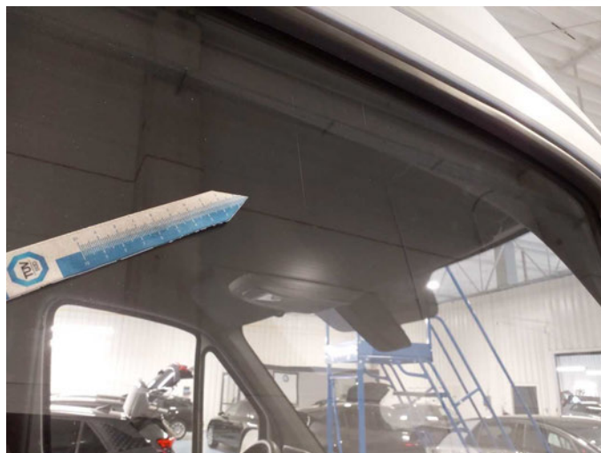
Beschädigung 31: Verglasung: Türscheibe vorn rechts - verkratzt / verschürft - kein Abzug
