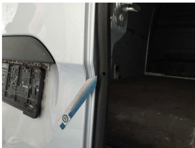
Beschädigung 33: Tür hinten links: Türdichtung - Löcher - kein Abzug
