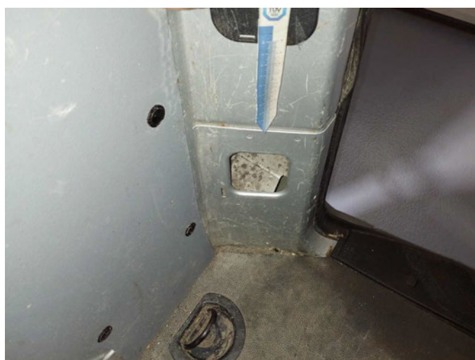
Beschädigung 40: Verkleidungen/Abdeckungen: Verkleidungen/ Abdeckungen - fehlt - kein Abzug
