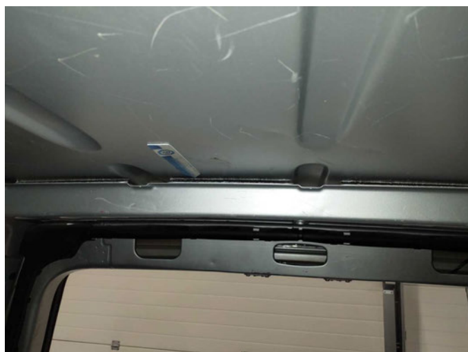
Beschädigung 47: Fahrzeugdach: Dach - verformt - kein Abzug
