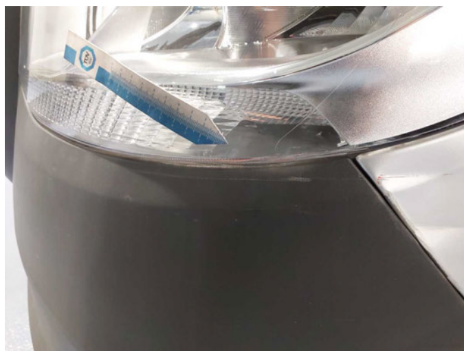
Beschädigung 23: Scheinwerfer: Scheinwerfer links - verkratzt / verschürft - kein Abzug
