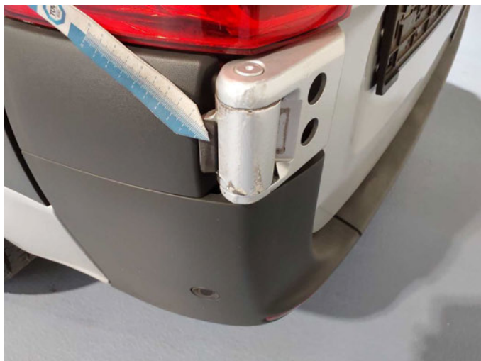
Beschädigung 27: Tür hinten links: Scharnier unten - verkratzt / verschürft - kein Abzug
