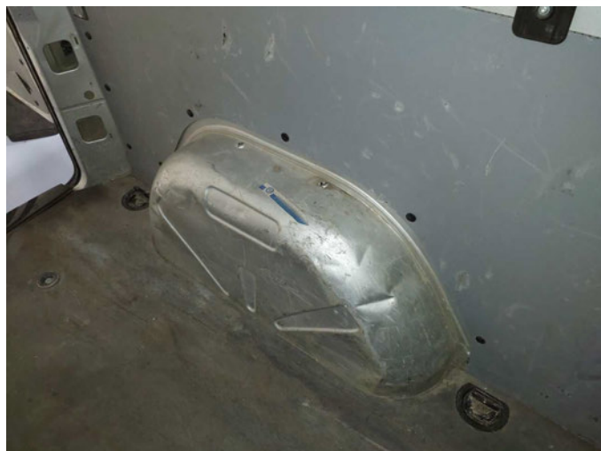
Beschädigung 46: Seitenwand links: Radlauf - Delle / Lackschaden - kein Abzug
