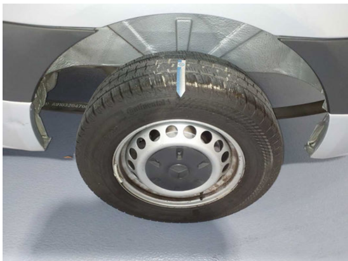
Beschädigung 5: Rad/Reifen: Reifen hinten links - abweichend Auslieferungszustand - kein Abzug
