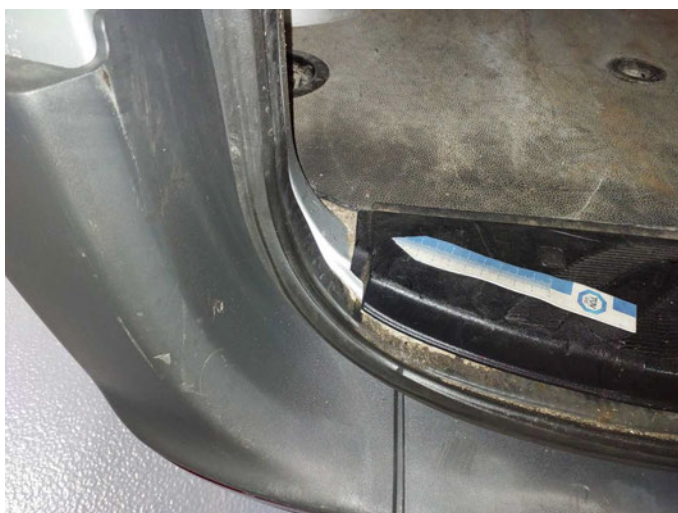
Beschädigung 37: Verkleidungen/Abdeckungen: Verkleidungen/Abdeckungen - Fehlstellung - kein Abzug
