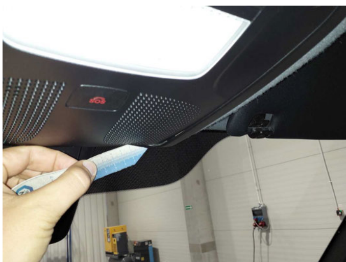
Beschädigung 4: Verkleidungen/Abdeckungen: Verkleidungen/ Abdeckungen - Fehlstellung - kein Abzug
