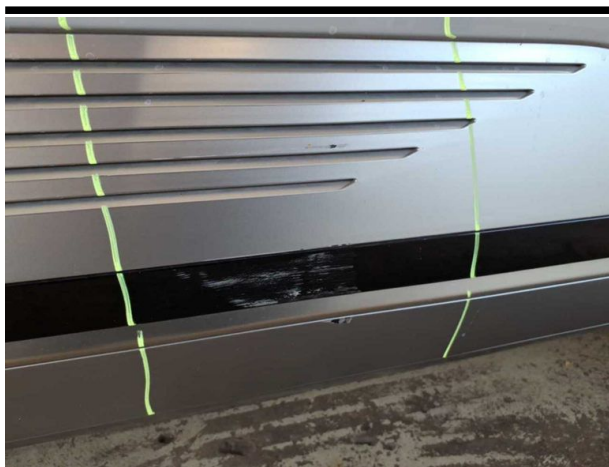
Beschädigung #7: Tür vorn rechts: Zierleiste unten - verkratzt / verschürft - erneuern
