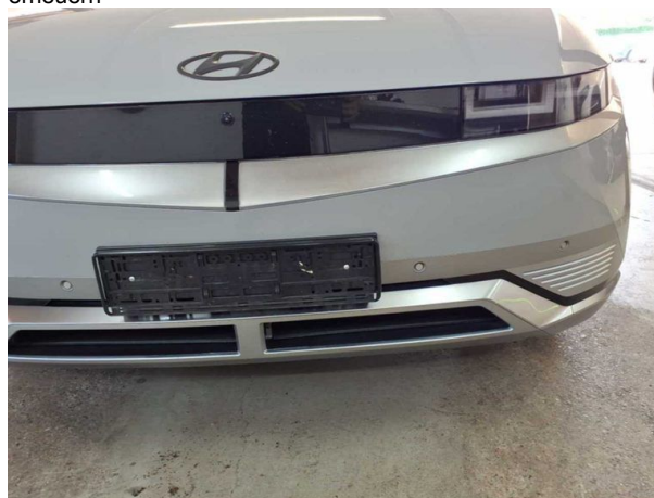
Beschädigung #10: Stossfänger vorn: Spoiler - verkratzt / verschürft - erneuern
