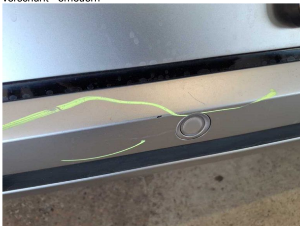
Beschädigung #8: Stossfänger hinten: Spoiler - verkratzt / verschürft - instandsetzen und lackieren
