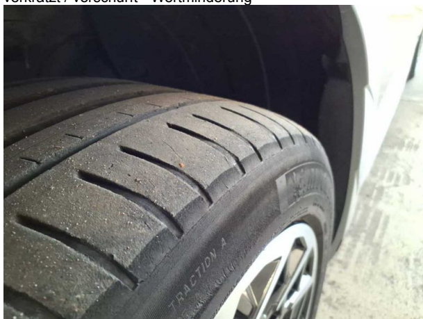
Beschädigung #5: Vermessung: Fahrwerk - Fehlstellung - befunden ggf. instandsetzen
