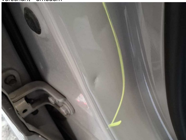
Beschädigung #11: Schweller rechts: Einstieg - Delle / Lackschaden - instandsetzen und lackieren
