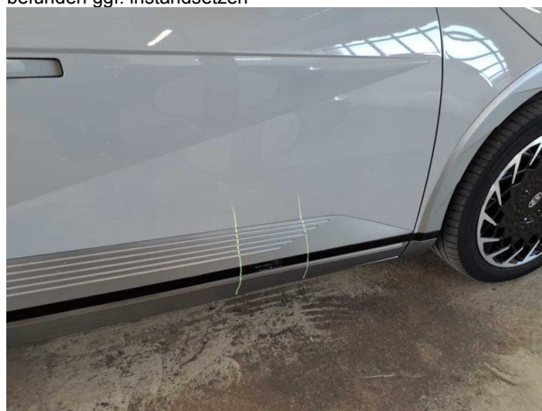
Beschädigung #7: Tür vorn rechts: Zierleiste unten - verkrat... verschürft - erneuern
