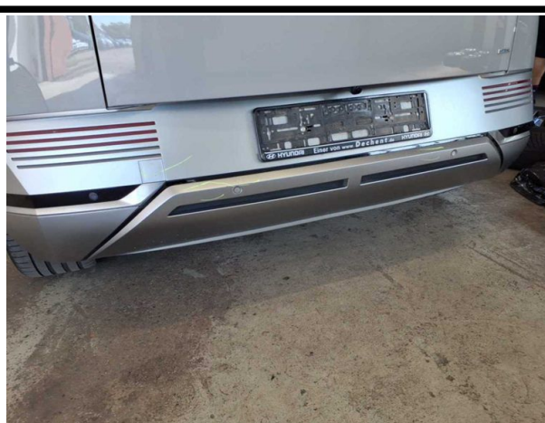
Beschädigung #8: Stossfänger hinten: Spoiler - verkratzt / verschürft - instandsetzen und lackieren
