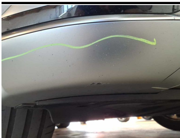
Beschädigung #10: Stossfänger vorn: Spoiler - verkratzt / verschürft - erneuern
