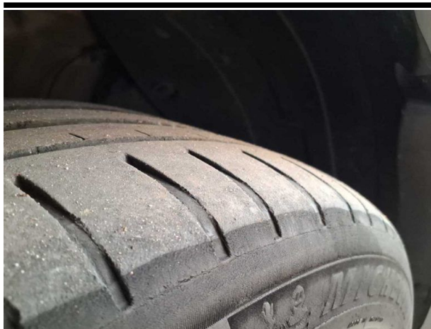
Beschädigung #9: Rad/Reifen: Reifen vorn - verschlissen - erneuern
