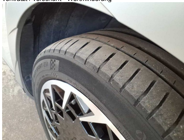
Beschädigung #5: Vermessung: Fahrwerk - Fehlstellung - befunden ggf. instandsetzen
