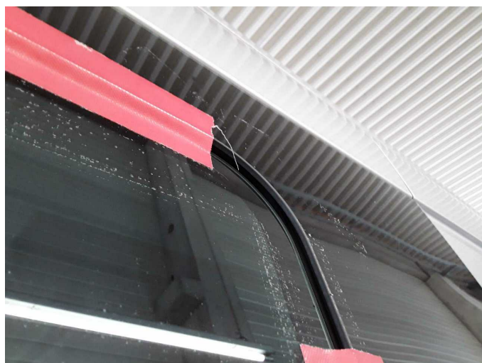
Damage 9: Vehicle glazing: Side window - rear left side (Schiebefenster, Zusatzkosten können entstehen) - Loose - Repair
