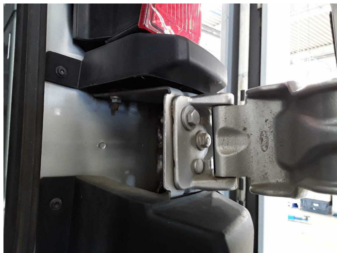
Damage 8: Boot lid / rear door: Hinge (rechts unten) - Malposition - Set / adjust
