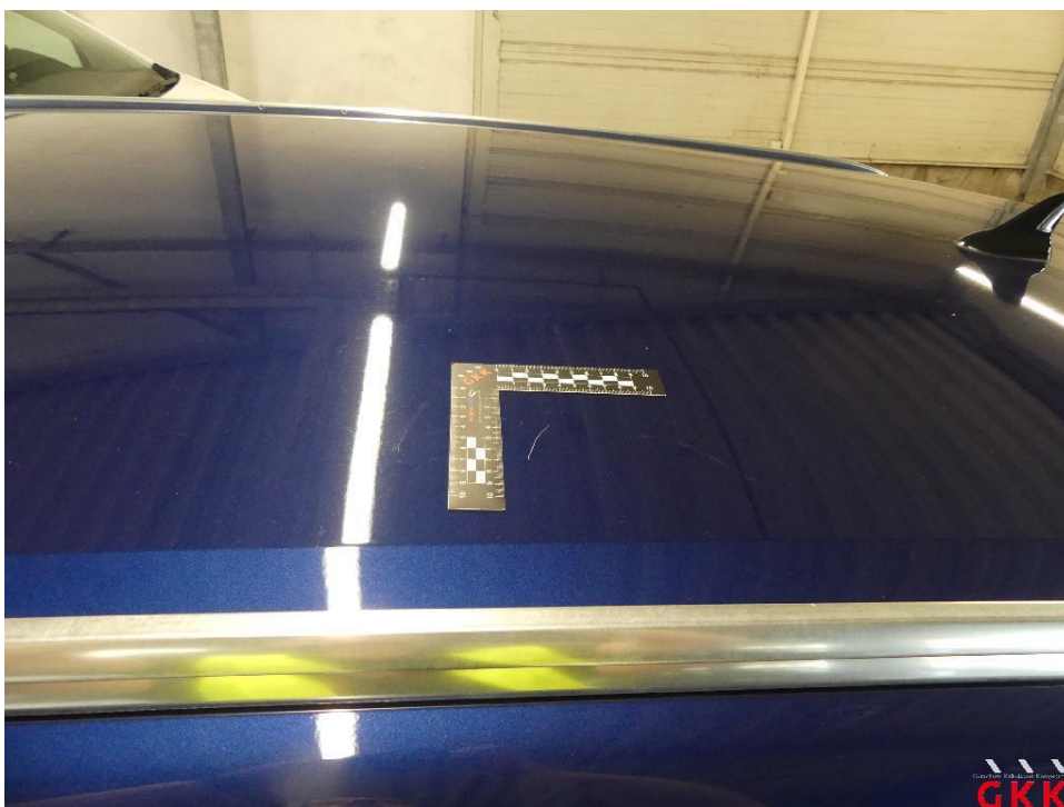
Bild 22 Dach, verkratzt, lackieren
