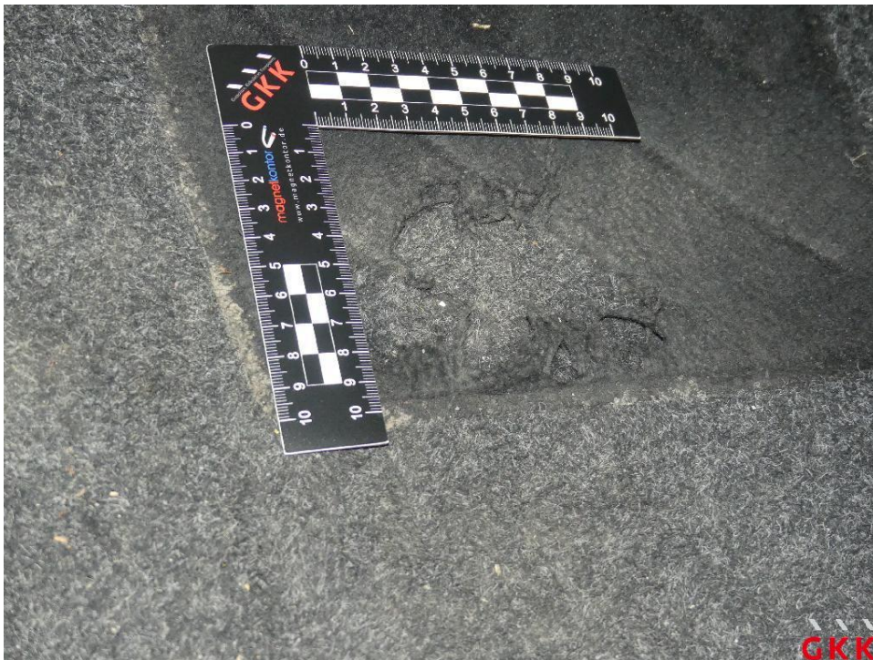
Bild 26 Fußmatte(n), vorne links, beschädigt, ersetzen
