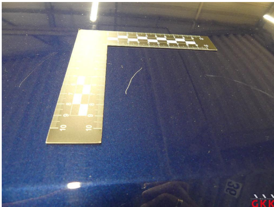
Bild 23 Dach, verkratzt, lackieren
