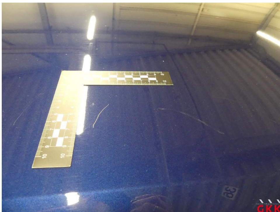
Bild 24 Dach, verkratzt, lackieren
