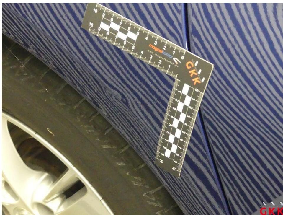
Bild 18 Seitenwand rechts, beschädigt, instand setzen - lackieren
