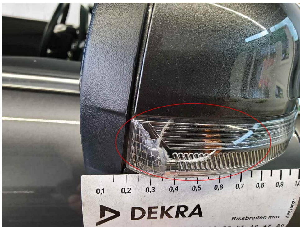
Bild 14 : Blinker Außenspiegel rechts, gebrochen
