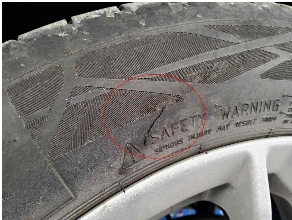
Bild 21 : Sommerreifen hinten links, Reifenflanke eingeschnitten
