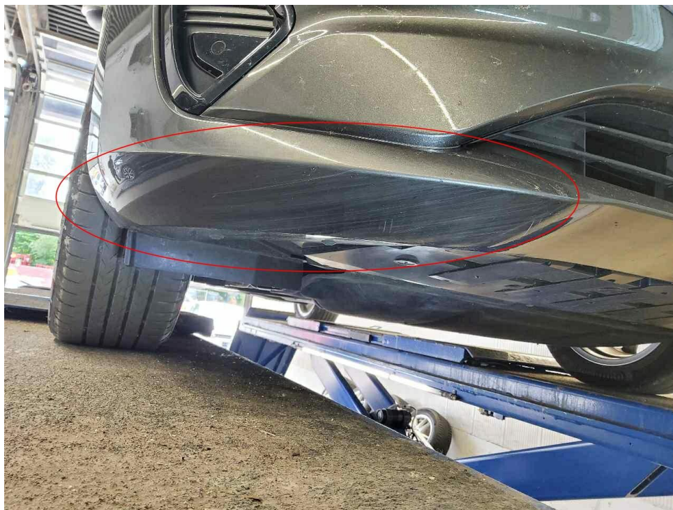
Bild 17 : Stoßfänger vorne Lackierung, verschrammt, lackieren mit Lackaufbau
