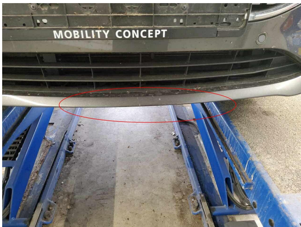
Bild 15 : Stoßfänger vorne Lackierung, verschrammt, lackieren mit Lackaufbau
