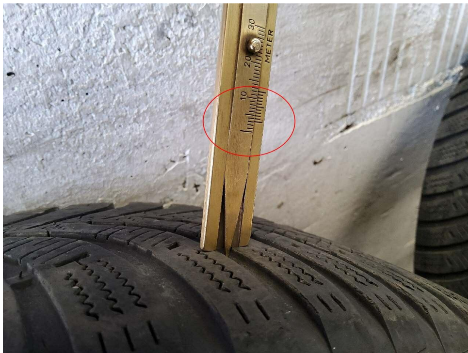
Bild 20 : Winterreifen vorne links, außerhalb Toleranzbereich
