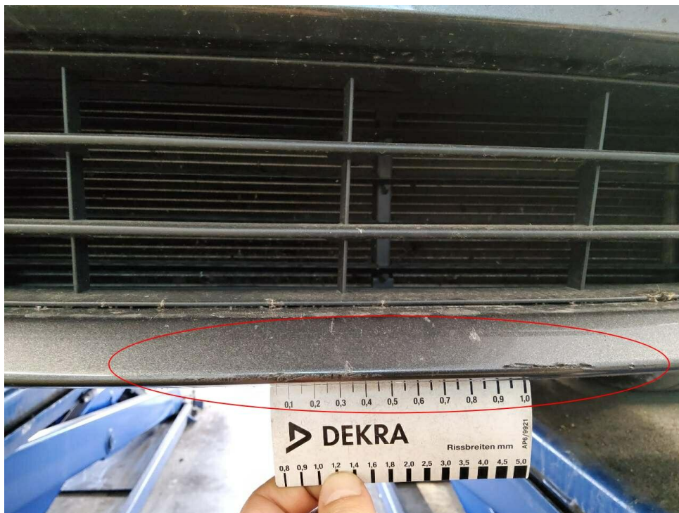
Bild 16 : Stoßfänger vorne Lackierung, verschrammt, lackieren mit Lackaufbau
