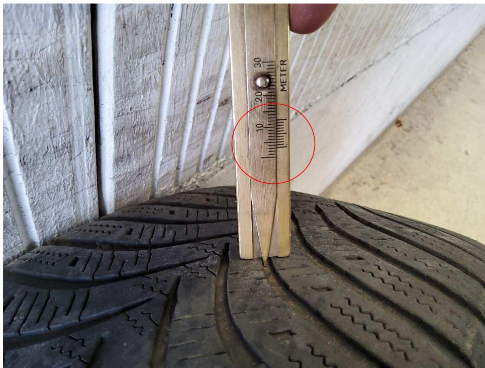
Bild 19 : Winterreifen vorne rechts, außerhalb Toleranzbereich
