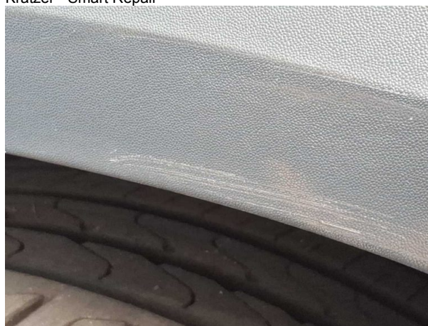
Beschädigung #3: Kotflügel rechts: Radhausverbreiterung - Kratzer - erneuern
