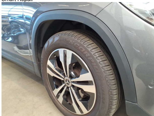
Beschädigung #3: Kotflügel rechts: Radhausverbreiterung - Kratzer - erneuern
