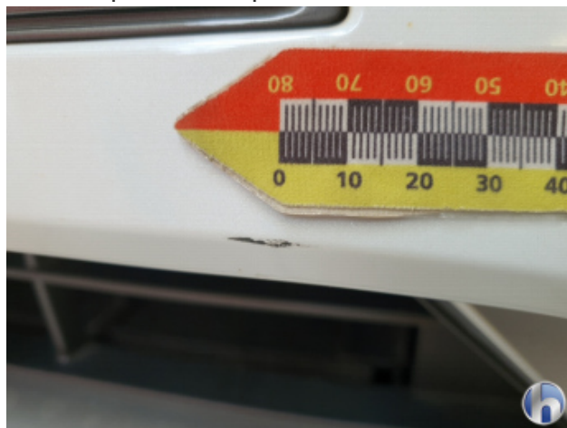
2. Stoßfänger Vorne Kratzer - Smart Repair
