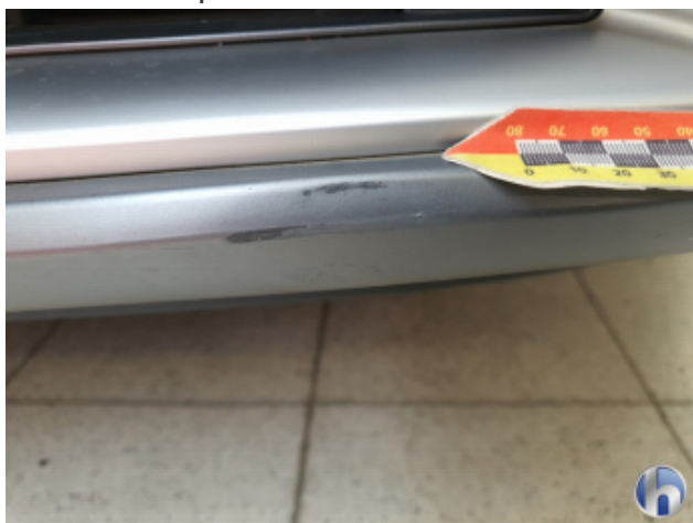
3. Frontspoiler Kratzer - Smart Repair
