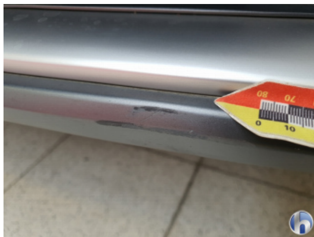
3. Frontspoiler Kratzer - Smart Repair
