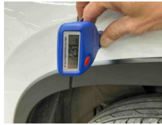
Lackstärke Seitenwand hinten links
