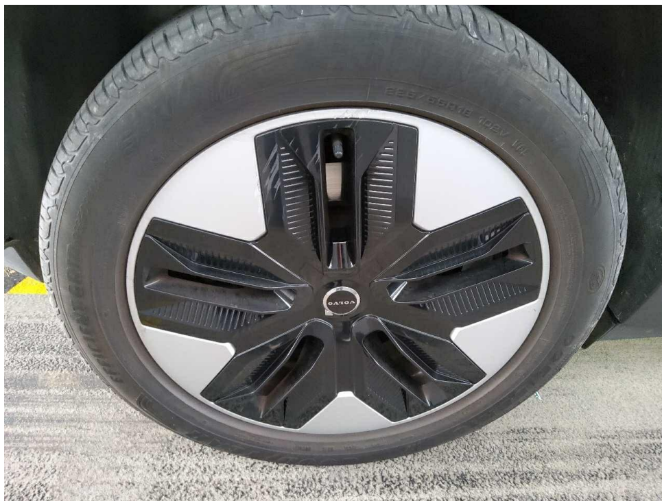
Bild 14 : Lm-Felge hinten rechts verkratzt
