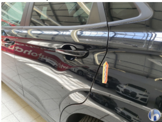
4. Seitenwand - Hinten - Links Kratzer - Smart Repair
