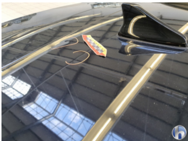
5. Dach 3 Dellen - Sanft Instandsetzen
