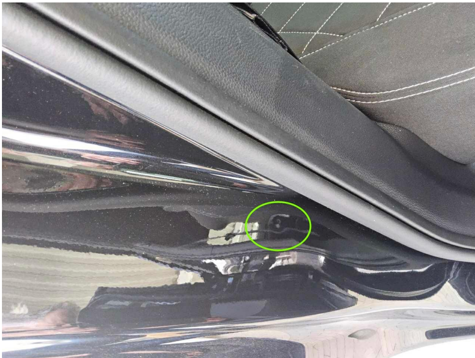
Bild 16 : Tür hinten rechts Einstieg, eingedellt, Gebrauchsspur
