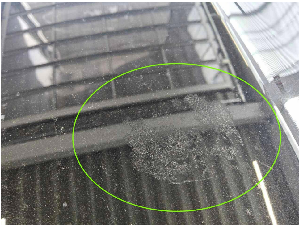
Bild 14 : Motorhaube Lackierung, Umweltschaden, lackieren mit Lackaufbau
