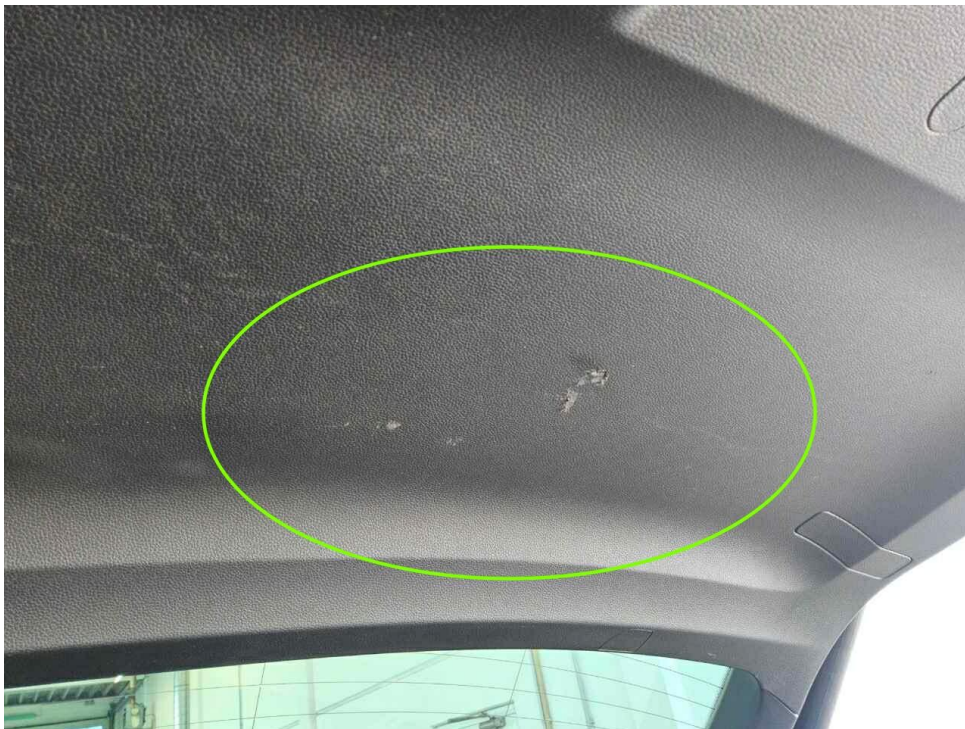
Bild 18 : Verkleidung Heckklappe, verschrammt, Gebrauchsspur
