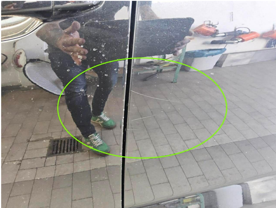
Bild 17 : Tür hinten links Lackierung, verschrammt, Gebrauchsspur
