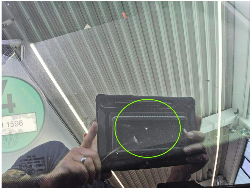
Bild 19 : Frontscheibe, Steinschlag, Gebrauchsspur
