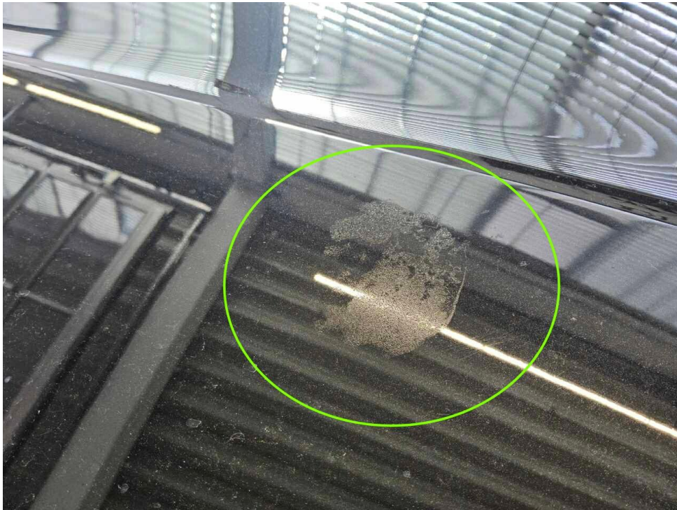
Bild 15 : Motorhaube Lackierung, Umweltschaden, lackieren mit Lackaufbau
