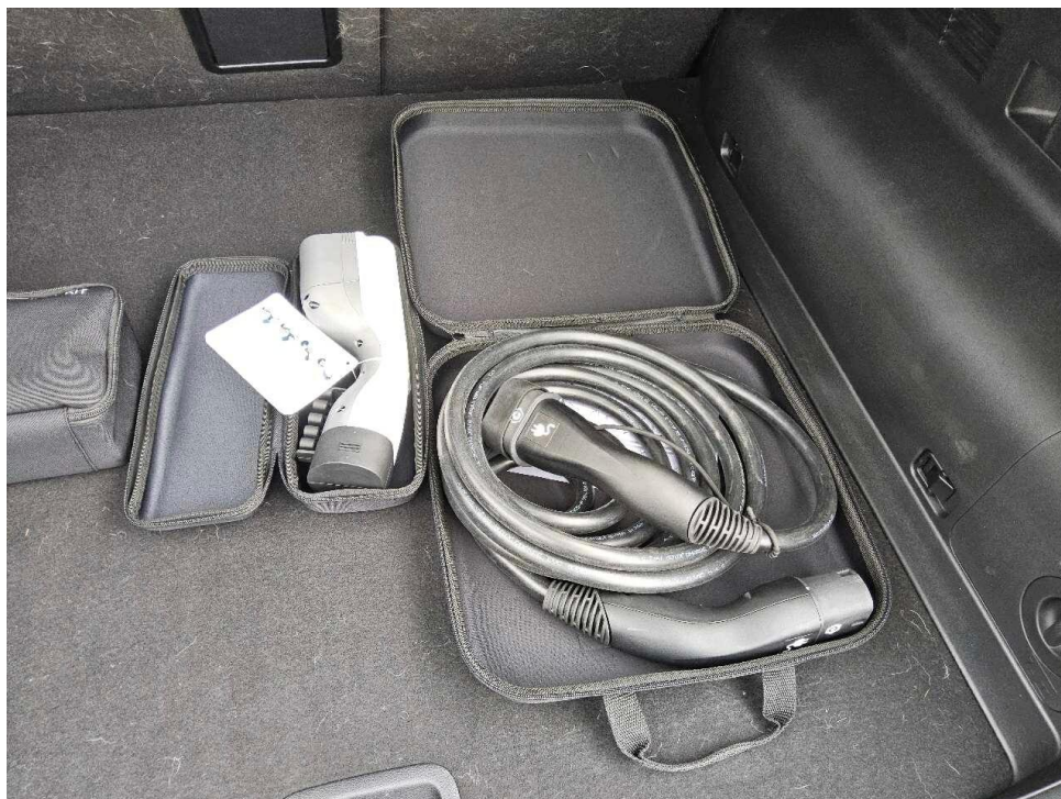
Bild 6 : Ladekabel beim E-Fahrzeug
