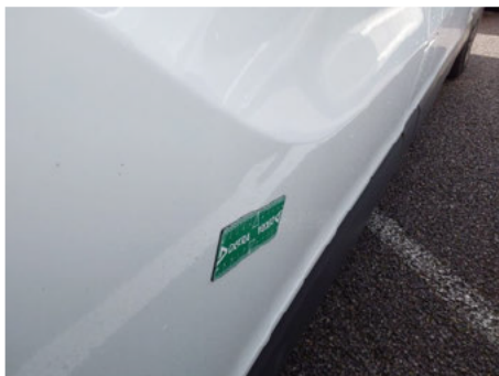
Porte / Avant Gauche / Enfoncement
