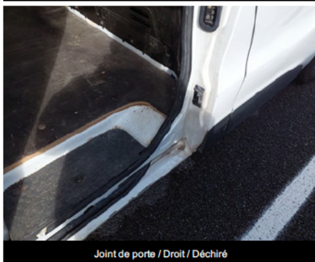
Joint de porte / Droit / Déchiré
