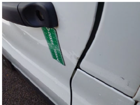
Porte / Avant Gauche / Enfoncement
