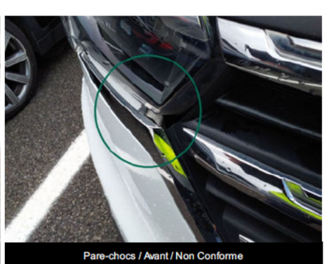
Pare-chocs / Avant / Non Conforme
