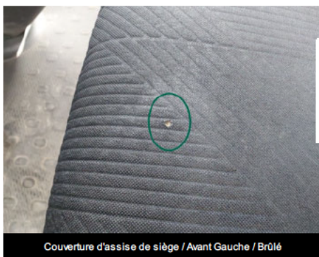
Couverture d'assise de siège / Avant Gauche / Brûlé
