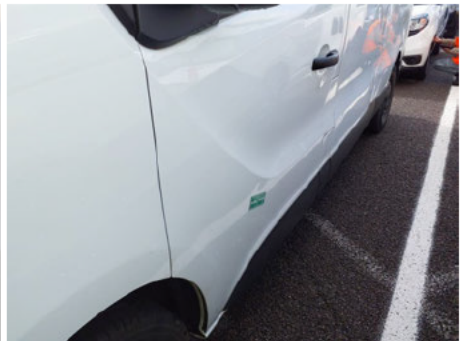
Porte / Avant Gauche / Enfoncement
