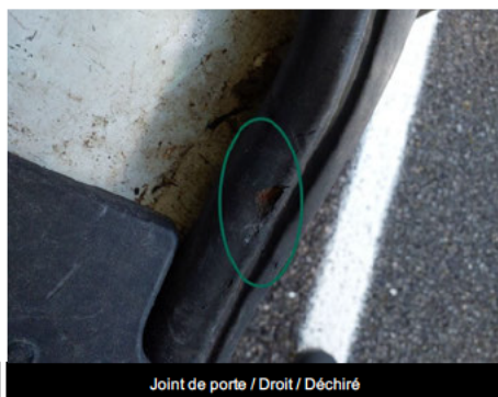
Joint de porte / Droit / Déchiré
