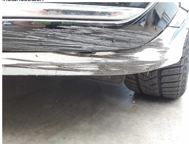
Beschädigung #2: Stossfänger vorn: Spoiler - verkratzt / verschürft - erneuern
