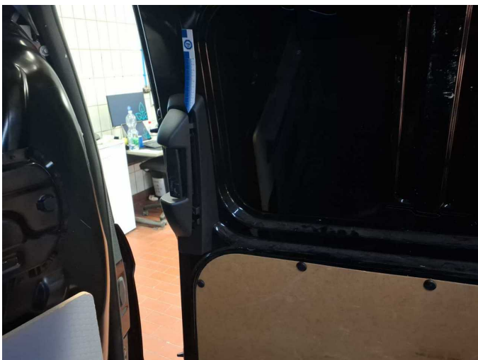
Damage 2: Sliding door, right: Door handle - inside (Verkleidung; Mehrkosten möglich) - Loose - Diagnosed and repair if necessary
