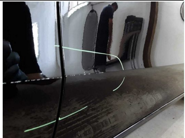
Beschädigung #5: Tür vorn rechts: Tür - verkratzt / verschürft... Smart Repair
