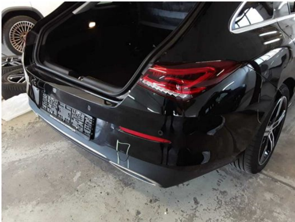
Beschädigung #13: Stossfänger hinten: Stossfänger hinten - beschädigt - erneuern
