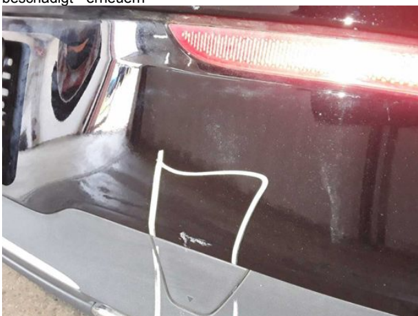
Beschädigung #13: Stossfänger hinten: Stossfänger hinten - beschädigt - erneuern
