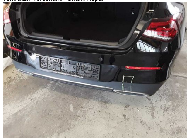
Beschädigung #7: Stossfänger hinten: Spoiler - verkratzt / verschürft - erneuern
