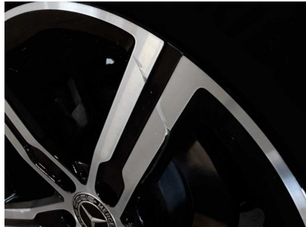
Beschädigung #9: Rad/Reifen: Leichtmetallfelge hinten rechts - verkratzt / verschürft - erneuern
