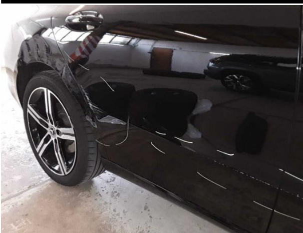
Beschädigung #14: Tür hinten rechts: Tür - verformt - erneuern
