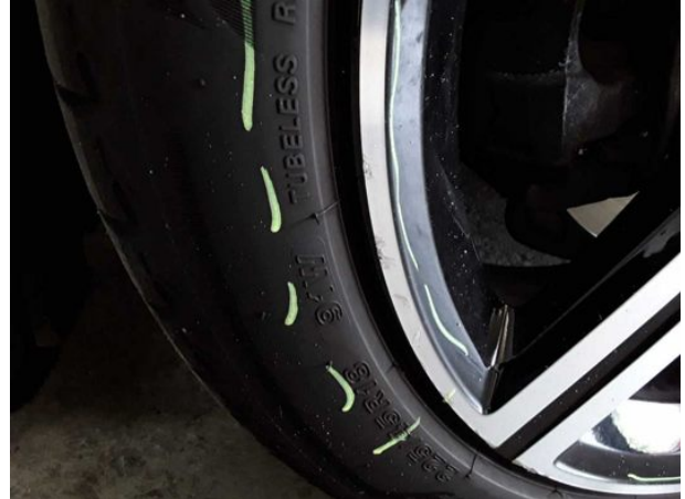
Beschädigung #2: Rad/Reifen: Leichtmetallfelge vorn links - verkratzt / verschürft - Wertminderung
