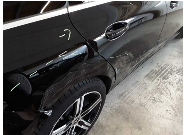
Beschädigung #15: Seitenwand rechts: Seitenwand - verformt - erneuern
