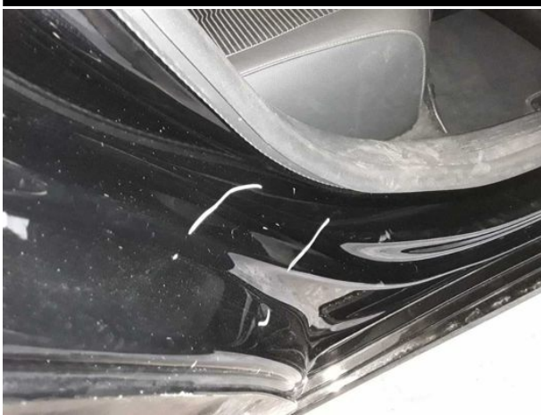
Beschädigung #4: Seitenwand rechts: Einstieg - verkratzt / verschürft - Smart Repair
