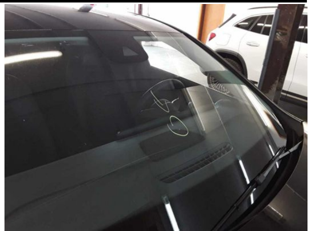
Beschädigung #10: Verglasung: Frontscheibe (Rissbildung) - Steinschlag - erneuern
