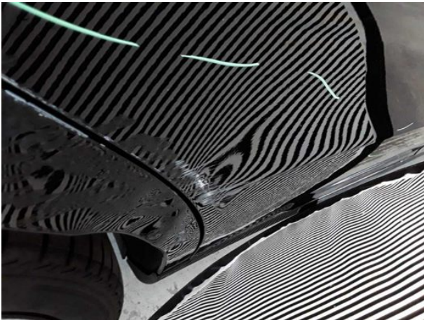
Beschädigung #14: Tür hinten rechts: Tür - verformt - erneuern
