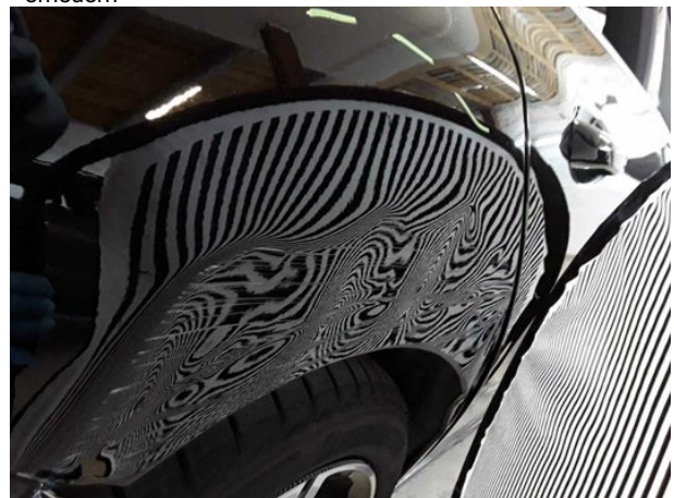
Beschädigung #15: Seitenwand rechts: Seitenwand - verformt - erneuern
