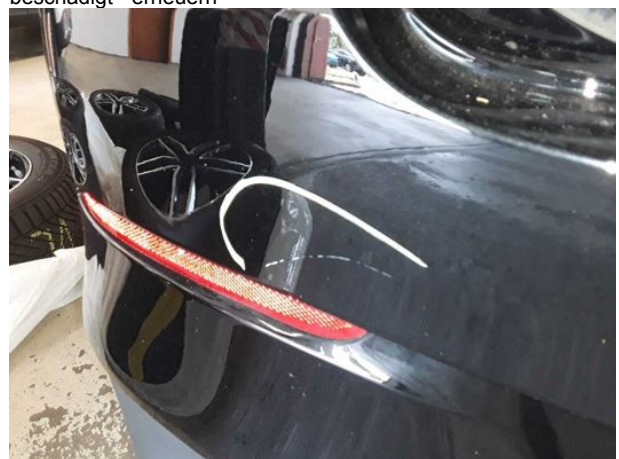
Beschädigung #13: Stossfänger hinten: Stossfänger hinten - beschädigt - erneuern
