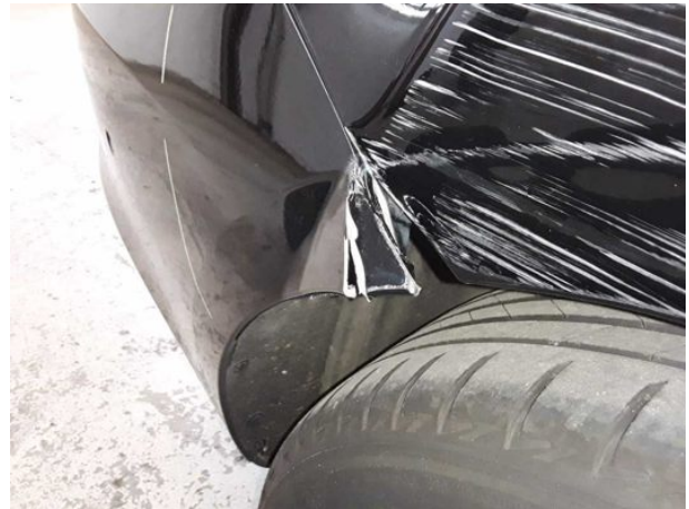
Beschädigung #13: Stossfänger hinten: Stossfänger hinten - beschädigt - erneuern
