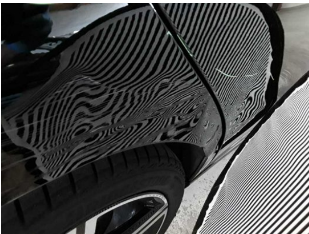
Beschädigung #15: Seitenwand rechts: Seitenwand - verformt - erneuern
