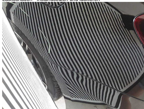
Beschädigung #7: Seitenwand links: Seitenwand - Delle / Lackschaden - instandsetzen und lackieren
