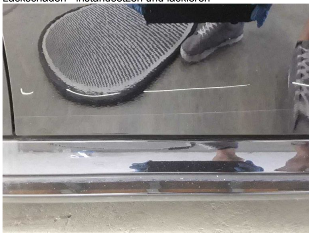
Beschädigung #8: Tür vorn rechts: Tür - verkratzt / verschürft - lackieren
