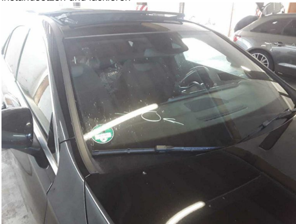
Beschädigung #10: Verglasung: Frontscheibe (Rissbildung) - Steinschlag - erneuern
