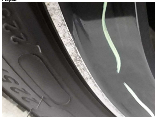
Beschädigung #3: 2.Radsatz: 2 Leichtmetallfelgen - verkratzt / verschürft - Wertminderung
