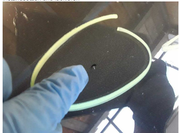
Beschädigung #10: Verglasung: Frontscheibe (Rissbildung) - Steinschlag - erneuern
