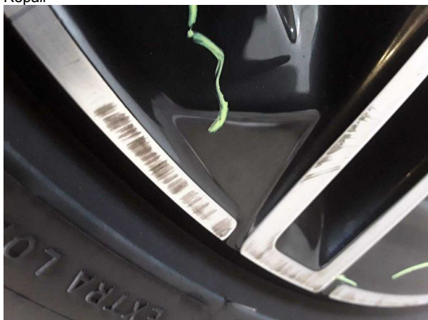
Beschädigung #3: 2.Radsatz: 2 Leichtmetallfelgen - verkratzt / verschürft - Wertminderung
