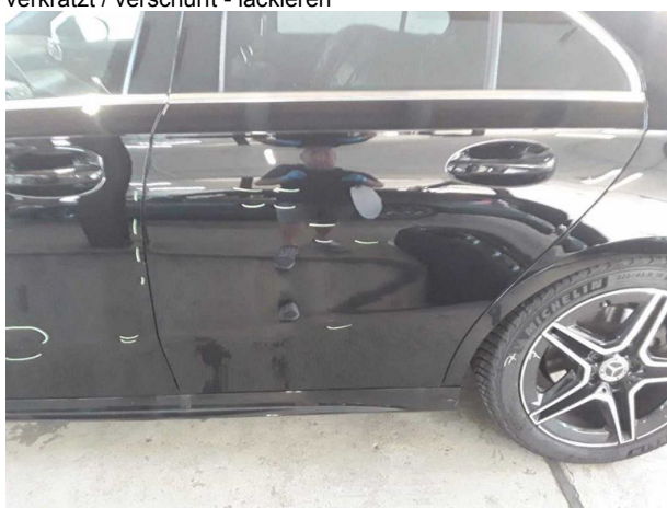
Beschädigung #5: Tür hinten links: Tür - verkratzt / verschürft - lackieren
