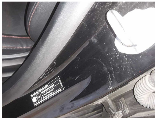
Beschädigung #1: Schweller links: Einstieg - Delle(n) - Smart Repair
