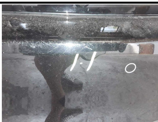
Beschädigung #4: Stossfänger hinten: Stossfänger hinten - verkratzt / verschürft - lackieren
