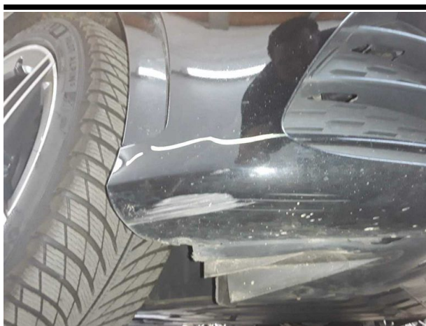
Beschädigung #6: Stossfänger vorn: Stossfänger vorn - verkratzt / verschürft - lackieren
