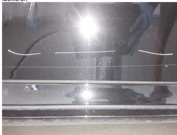
Beschädigung #8: Tür vorn rechts: Tür - verkratzt / verschürft... lackieren
