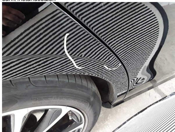
Beschädigung #4: Seitenwand rechts: Seitenwand - Delle(n) - sanft instandsetzen
