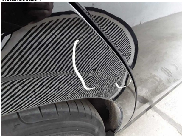
Beschädigung #4: Seitenwand rechts: Seitenwand - Delle(n) - sanft instandsetzen
