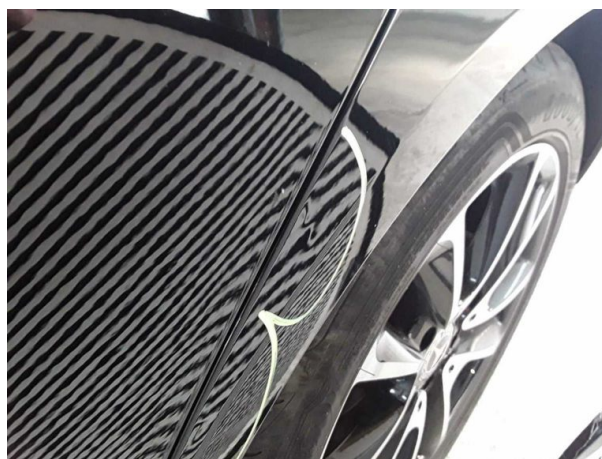
Beschädigung #3: Seitenwand links: Seitenwand - Delle(n) - sanft instandsetzen
