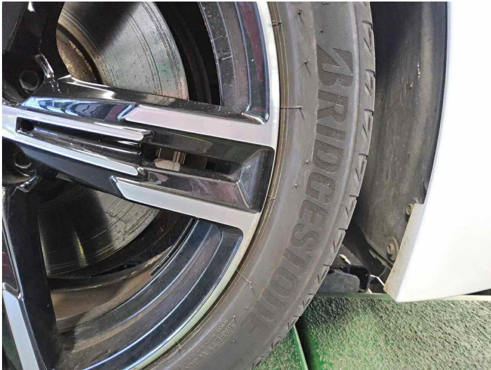
Bild 15 : Leichtmetallfelge glanzgedreht vorn rechts, verschrammt
