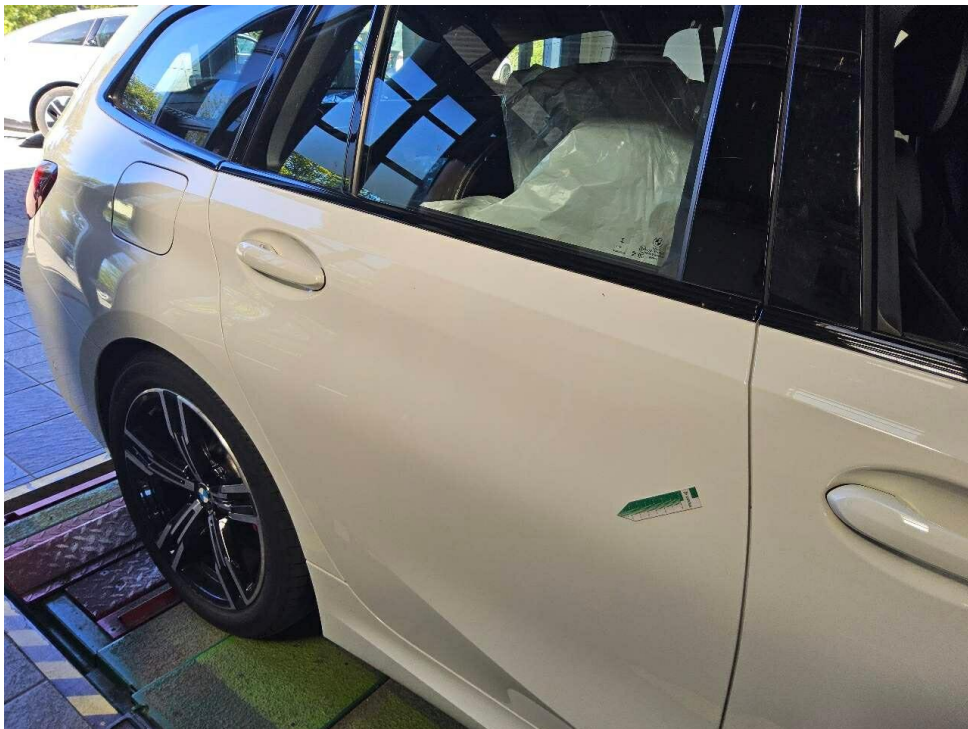
Bild 16 : Tür hinten rechts, eingedellt
