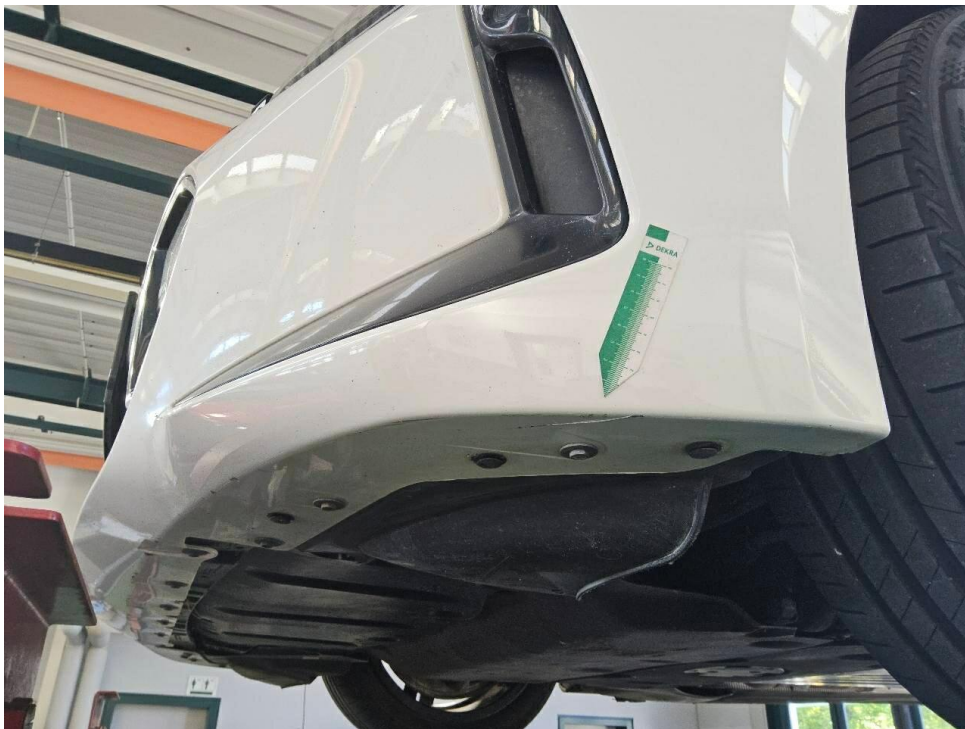
Bild 18 : Stoßfänger vorn unterhalb, verschrammt
