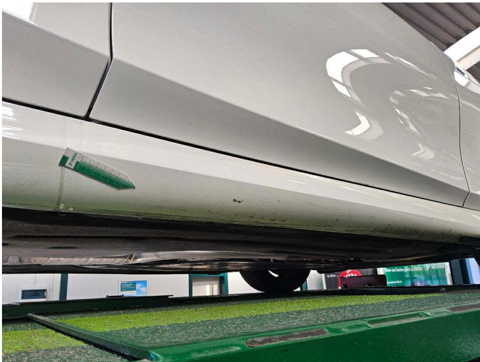
Bild 20 : Schwellerverkleidung rechts, verschrammt
