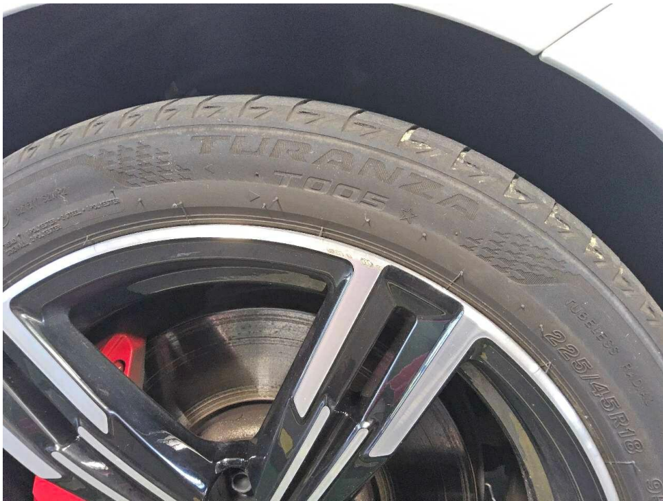
Bild 14 : Leichtmetallfelge glanzgedreht vorn rechts, verschrammt
