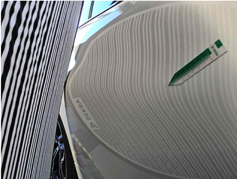
Bild 17 : Tür hinten rechts, eingedellt
