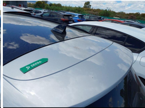
Portón trasero / puerta del maletero / - / Daño por granizo
