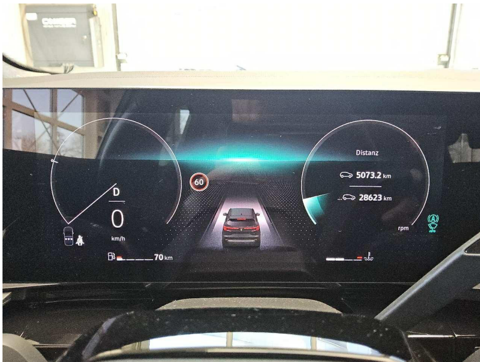
Bild 6 : Kombiinstrument (betriebsbereit) mit Kilometerstand
