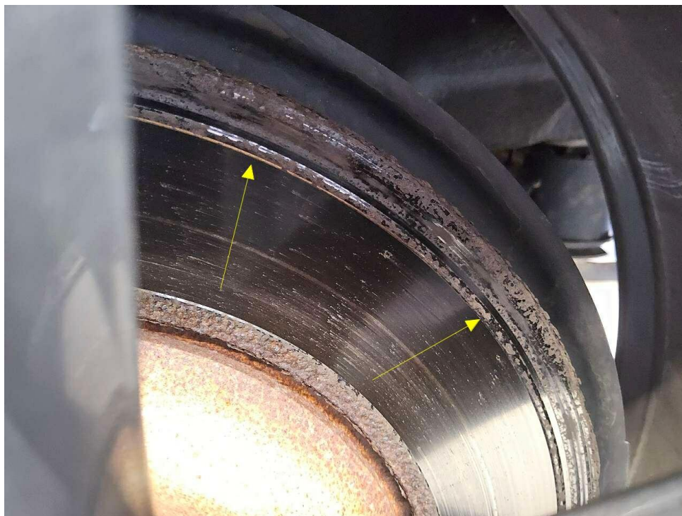
Bild 28 : Bremsscheibe hinten links, Tragbild mangelhaft
