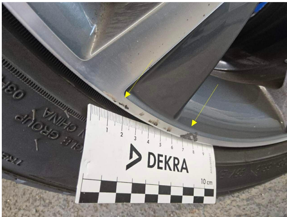
Bild 27 : LM Felge hinten rechts glanzgedreht verschrammt
