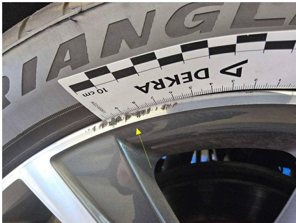
Bild 26 : LM Felge hinten rechts glanzgedreht verschrammt
