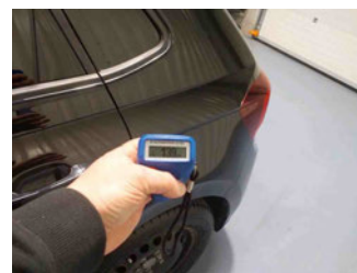
Lackstärke Seitenwand hinten links
