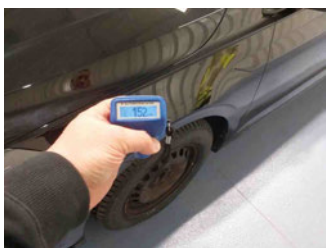
Lackstärke Kotflügel vorne links
