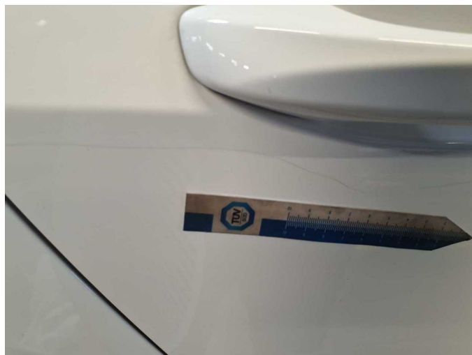
Damage 4: Door - rear right side: Door (Mehrkosten möglich) - Scratched - Conditioning
