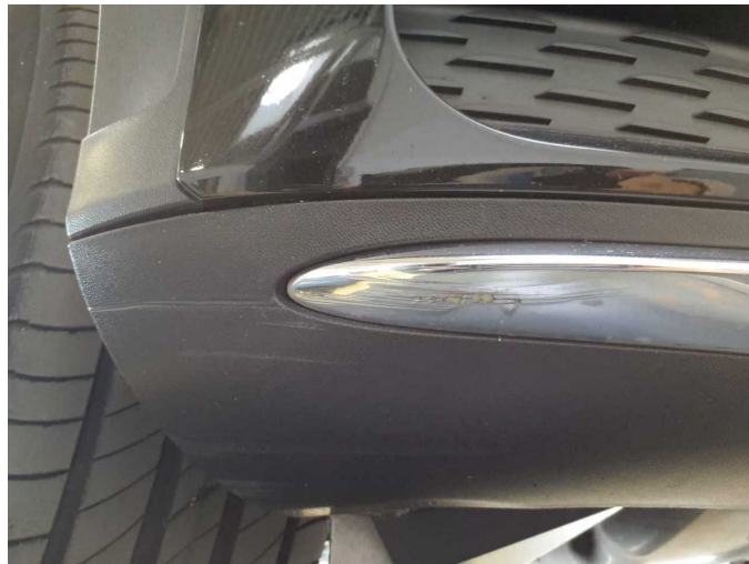
Damage 1: Front bumper: Spoiler (Zusätzlich Zierleiste Kratzer) - Scratch(es) - Loss in value
