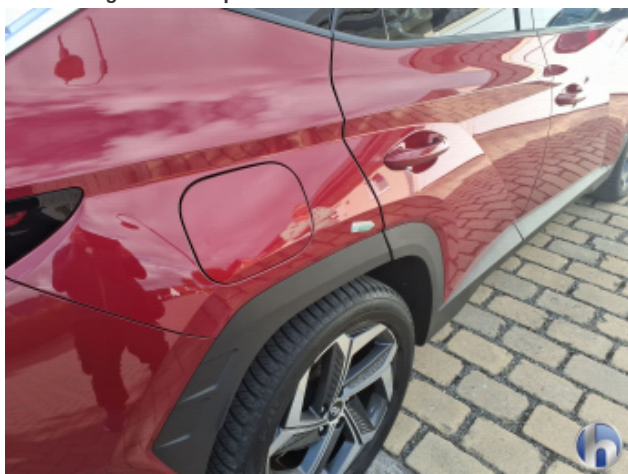
2. Seitenwand - Hinten - Links Verdellt - Sanft Instandsetzen
