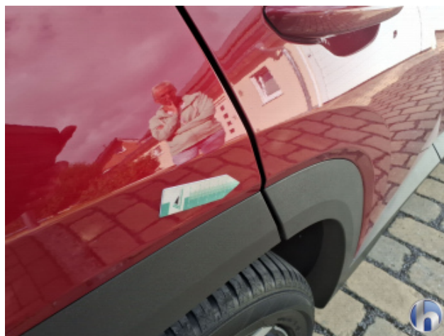
2. Seitenwand - Hinten - Rechts Verdellt - Sanft Instandsetzen
