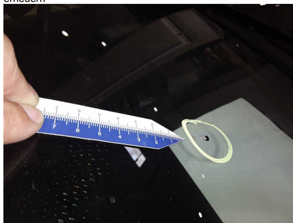
Beschädigung #5: Verglasung: Frontscheibe - Steinschlag - erneuern
