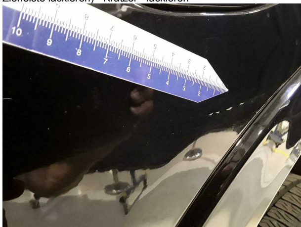
Beschädigung #4: Seitenwand links: Seitenwand (inklusive Zierleiste lackieren) - Kratzer - lackieren
