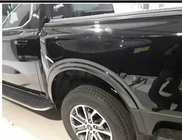
Beschädigung #4: Seitenwand links: Seitenwand (inklusive Zierleiste lackieren) - Kratzer - lackieren
