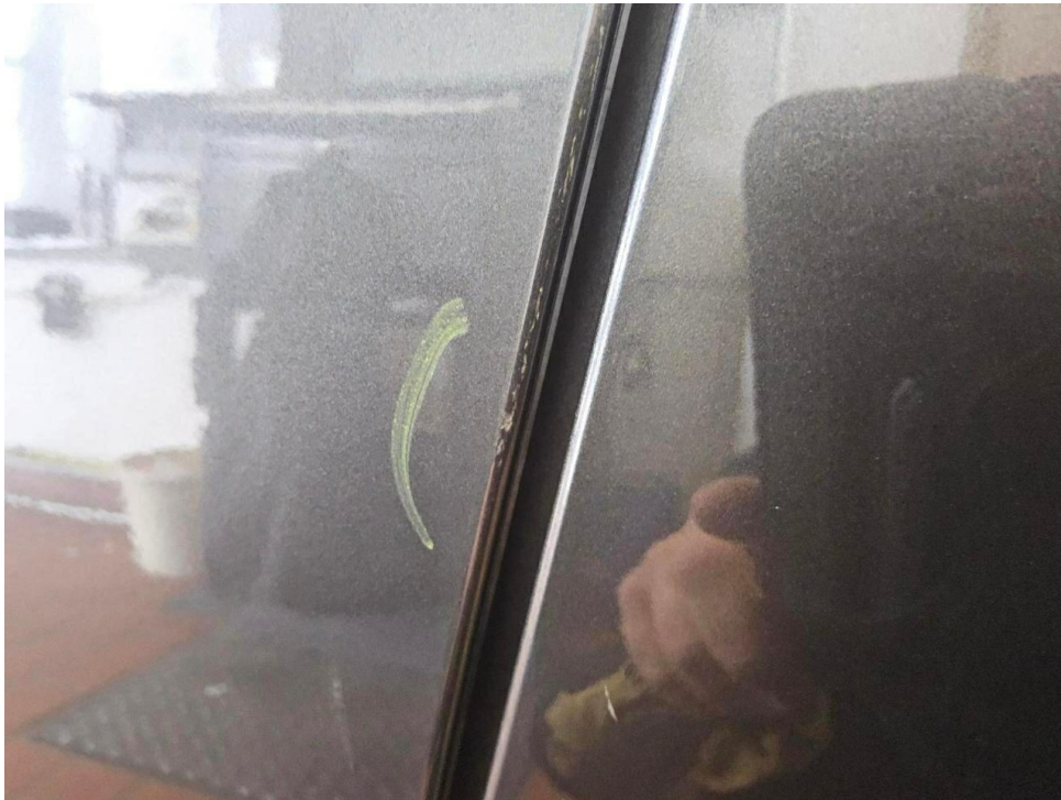
Bild 23 : Tür vorne links Türkante, Lackabplatzer, Gebrauchsspur
