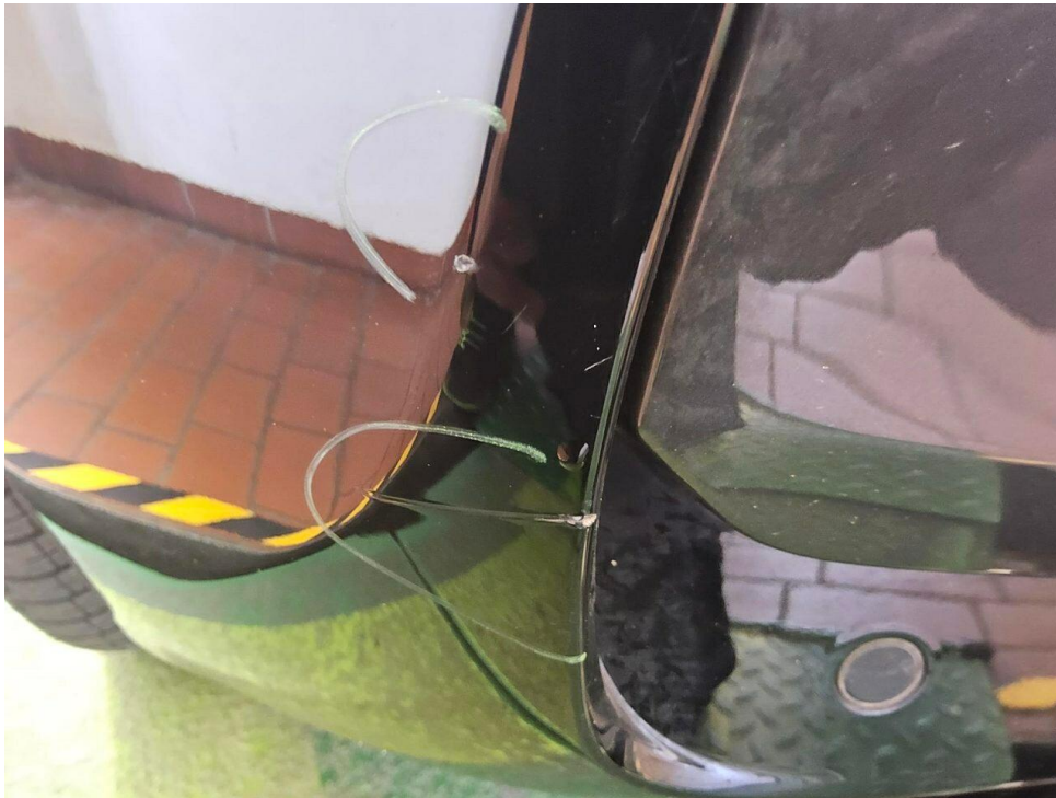
Bild 21 : Stoßfänger hinten Lackierung, zerkratzt, lackieren mit Lackaufbau
