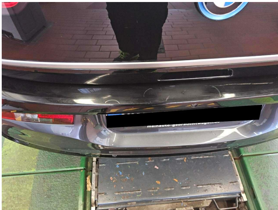
Bild 18 : Stoßfänger hinten Lackierung, zerkratzt, lackieren mit Lackaufbau
