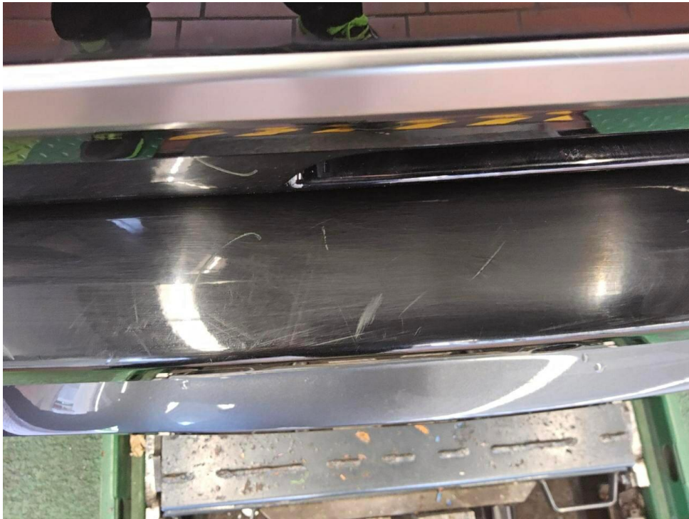
Bild 19 : Stoßfänger hinten Lackierung, zerkratzt, lackieren mit Lackaufbau
