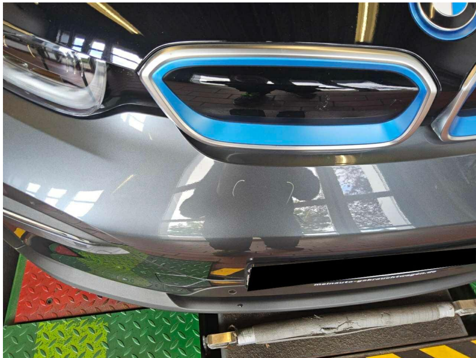
Bild 26 : Stoßfänger vorne Lackierung, zerkratzt, polieren
