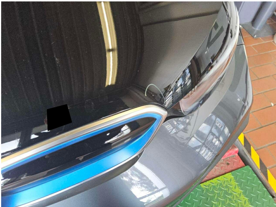
Bild 24 : Motorhaube Lackierung, Steinschlag, Gebrauchsspur
