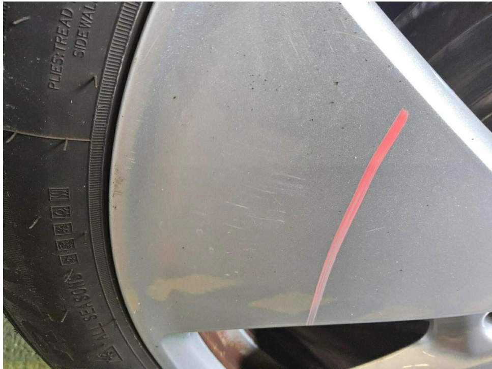
Bild 17 : Felge hinten rechts Lackierung, verschrammt, Gebrauchsspur
