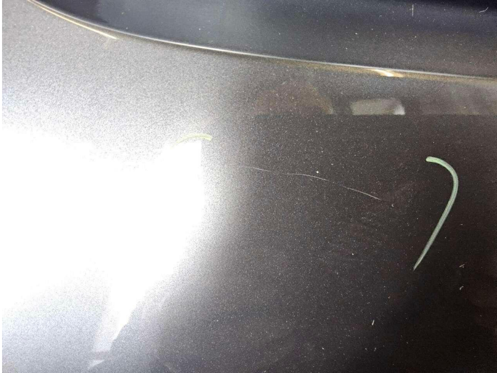
Bild 27 : Stoßfänger vorne Lackierung, zerkratzt, polieren
