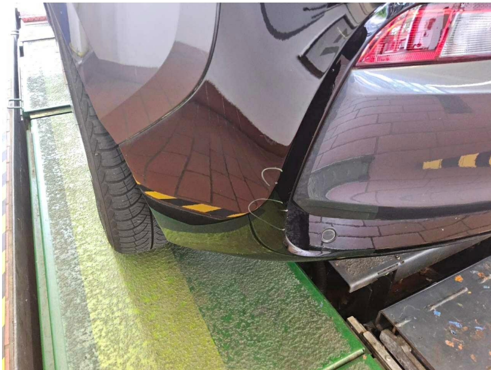
Bild 20 : Stoßfänger hinten Lackierung, zerkratzt, lackieren mit Lackaufbau
