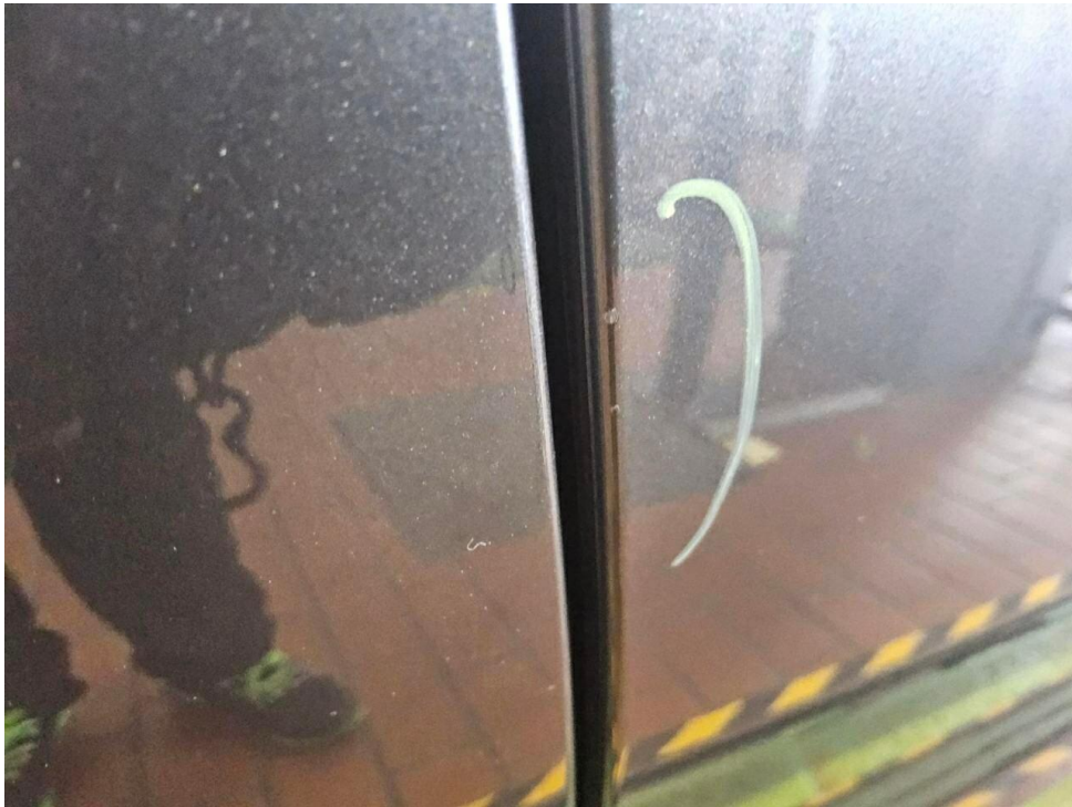
Bild 15 : Tür vorne rechts Türkante, Lackabplatzer, Gebrauchsspur
