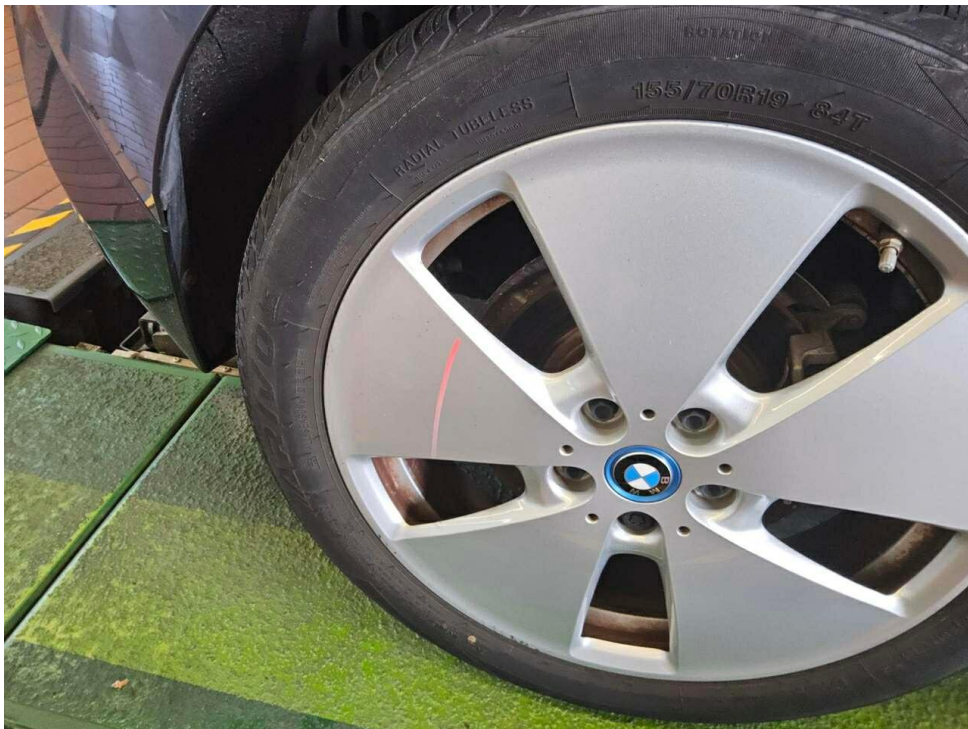
Bild 16 : Felge hinten rechts Lackierung, verschrammt, Gebrauchsspur
