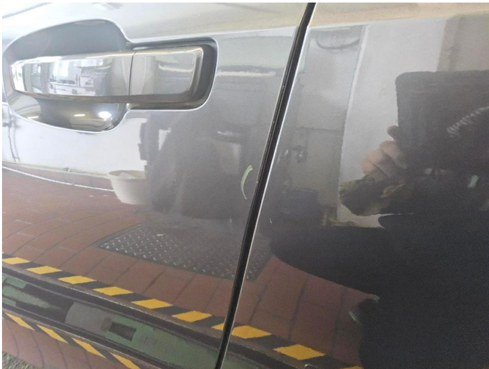
Bild 22 : Tür vorne links Türkante, Lackabplatzer, Gebrauchsspur
