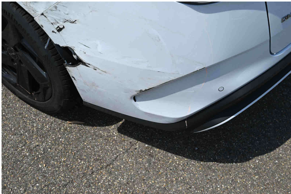
Bild 6 Stossfänger hinten links aufgerissen
