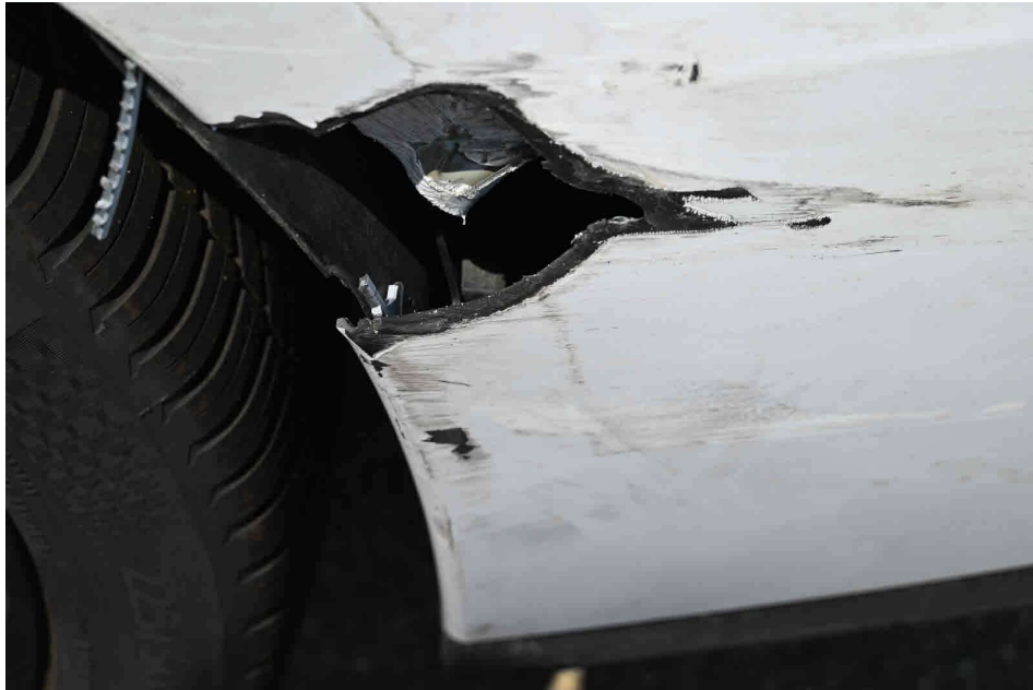
Bild 13 Seitenwand hinten links aufgerissen
