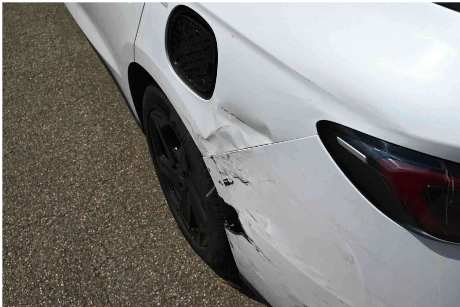
Bild 10 Verformung am Radlauf
