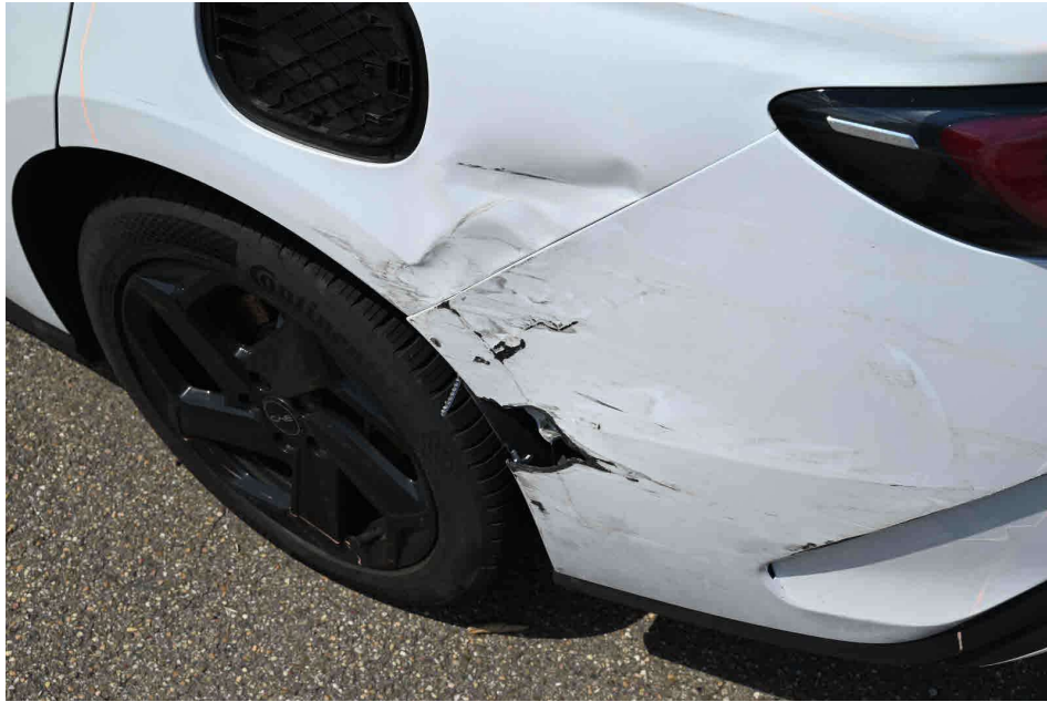
Bild 7 Seitenwand links verformt
