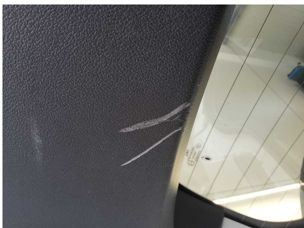
Beschädigung #6: Verkleidungen/Abdeckungen: Heckdeckel, Innenverkleidung - verkratzt / verschürft - erneuern
