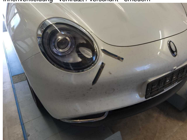
Beschädigung #7: Stossfänger vorn: Stossfänger vorn - Lackmangel - lackieren
