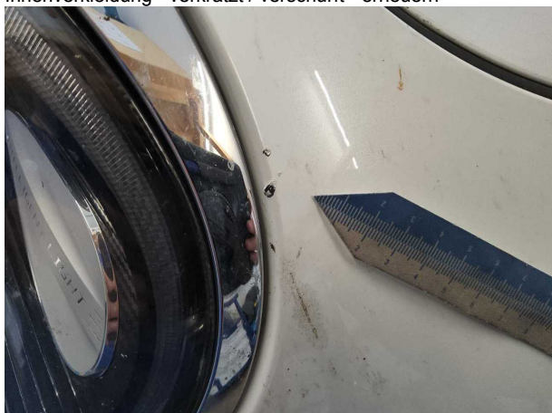
Beschädigung #7: Stossfänger vorn: Stossfänger vorn - Lackmangel - lackieren
