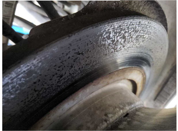
Beschädigung #8: Bremsanlage: Bremsscheiben und Beläge hinten - Korrosion - erneuern
