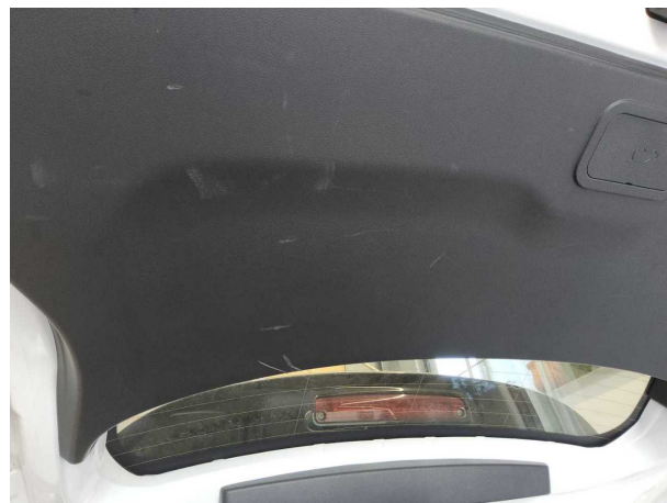
Beschädigung #6: Verkleidungen/Abdeckungen: Heckdeckel, Innenverkleidung - verkratzt / verschürft - erneuern
