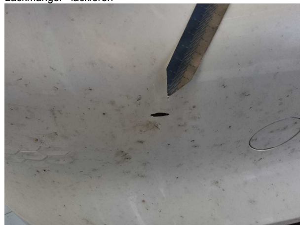
Beschädigung #7: Stossfänger vorn: Stossfänger vorn - Lackmangel - lackieren
