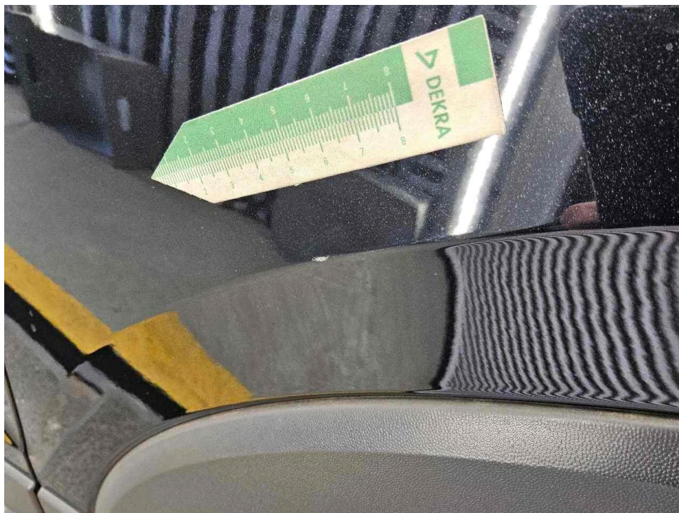
Bild 17 : Kotflügel rechts im Kantenbereich deformiert und zerkratzt
