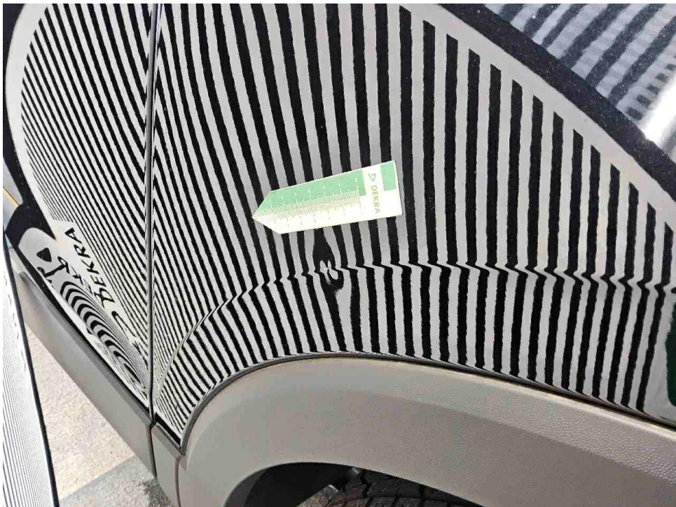
Bild 16 : Kotflügel rechts im Kantenbereich deformiert und zerkratzt
