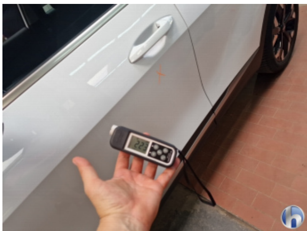
1. Tür Vorne - Links Nachlackiert - Ohne Reparatur
