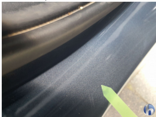
8. Schweller - Rechts Oberflächenkratzer - Aufbereiten / Polieren
