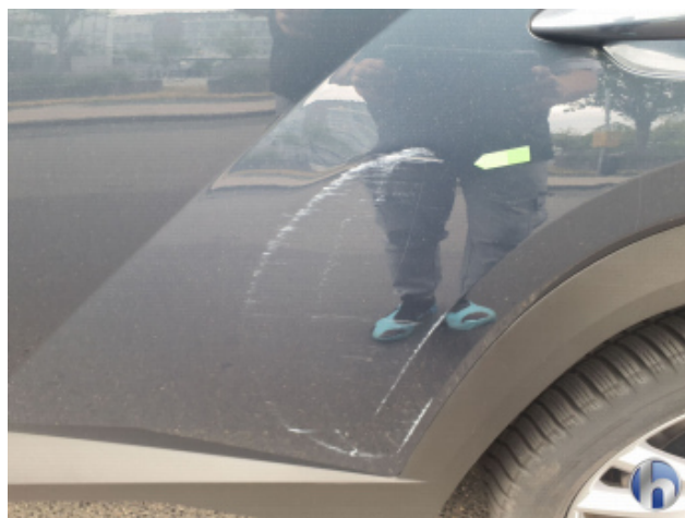
6. Tür Hinten - Links Kratzer - Instandsetzen und Lackieren
