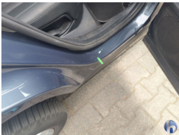
8. Schweller - Rechts Oberflächenkratzer - Aufbereiten / Polieren
