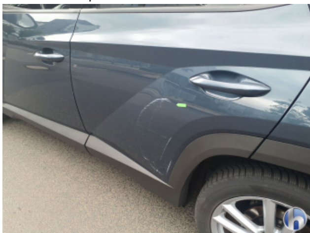
6. Tür Hinten - Links Kratzer - Instandsetzen und Lackieren
