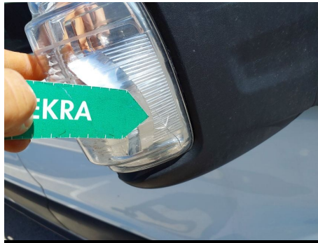
Piloto del intermitente / Derecha / Roto
