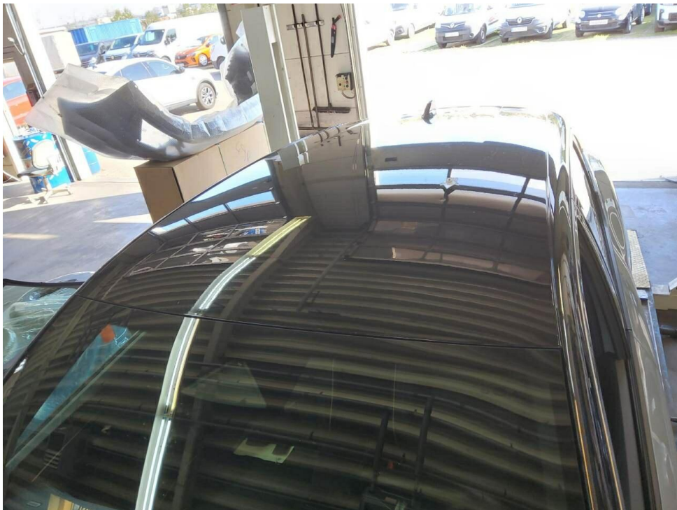
Bild 12 : Dach, eingedellt, drücken
