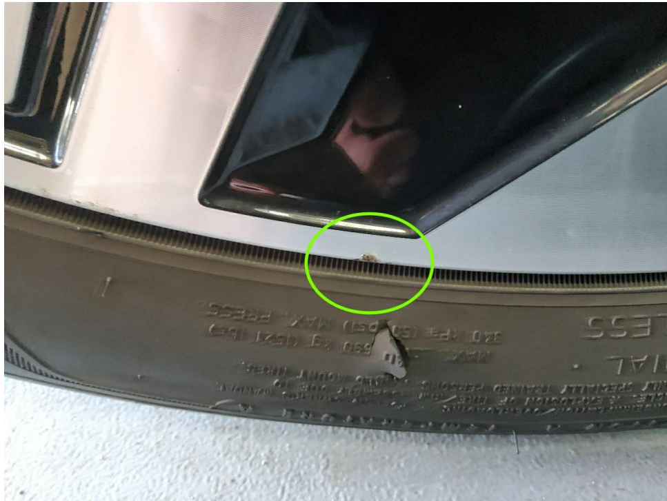
Bild 19 : Glanzgedrehte Alufelge hinten rechts, zerkratzt mit Materialabrieb
