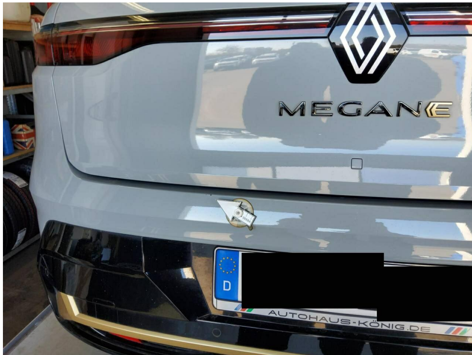
Bild 13 : Stoßfänger hinten Lackierung, verschrammt, smart repair
