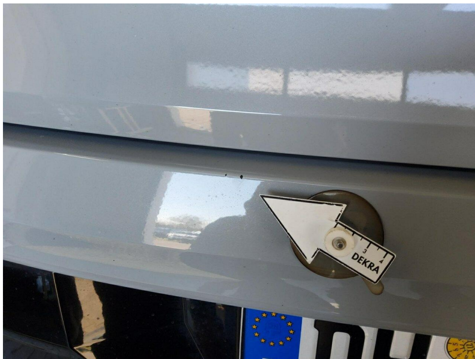
Bild 14 : Stoßfänger hinten Lackierung, verschrammt, smart repair
