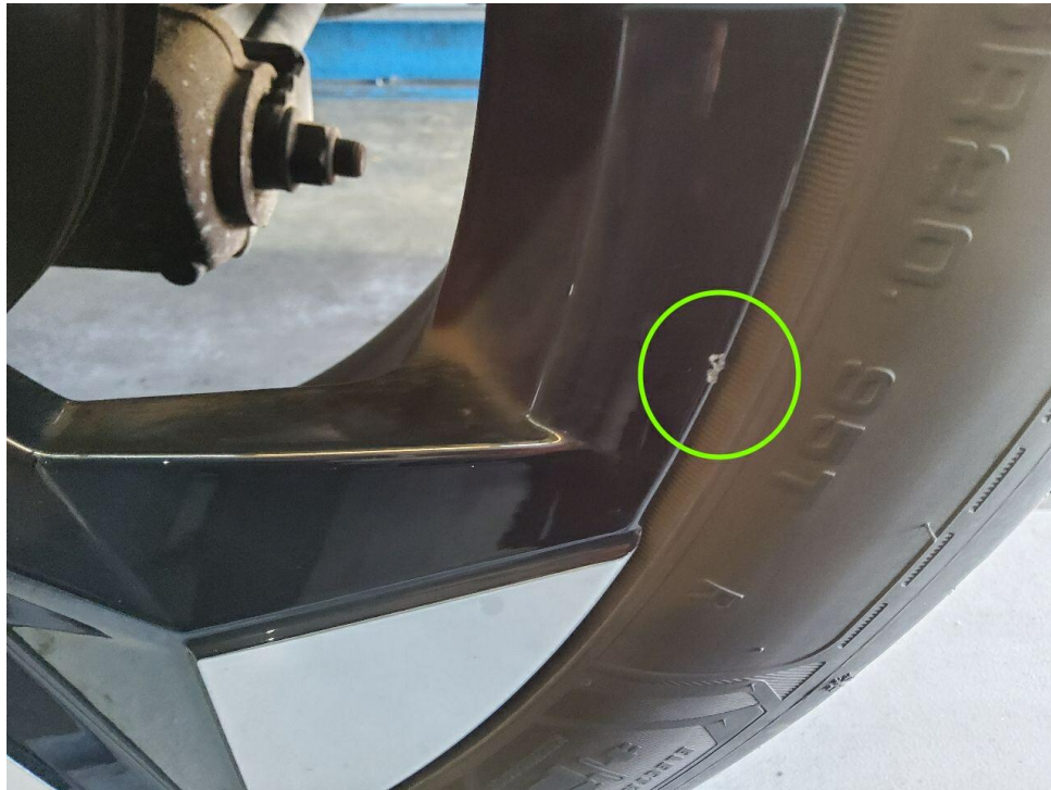
Bild 17 : Glanzgedrehte Alufelge hinten links, verschrammt kleiner 10mm
