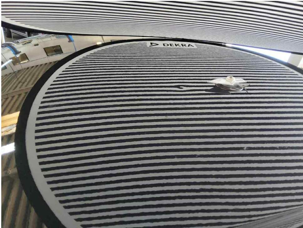
Bild 11 : Dach, eingedellt, drücken
