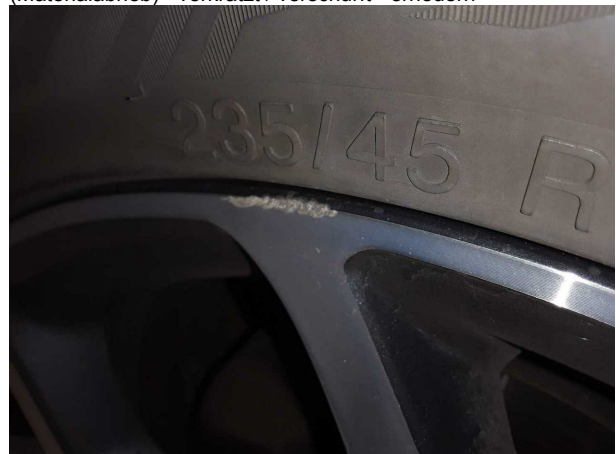
Beschädigung #1: Rad/Reifen: Leichtmetallfelge vorn rechts (Materialabrieb) - verkratzt / verschürft - erneuern
