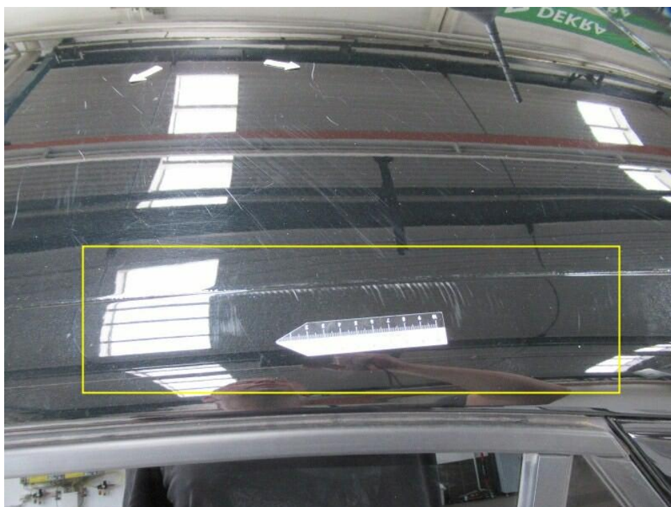
Bild 26 : Dachrahmen links Lackierung, zerkratzt, lackieren mit Lackaufbau
