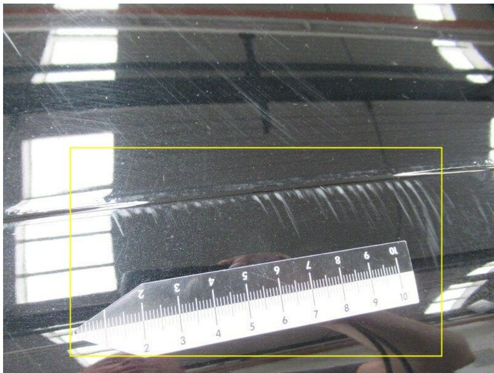
Bild 27 : Dachrahmen links Lackierung, zerkratzt, lackieren mit Lackaufbau
