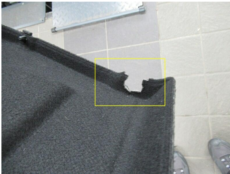
Bild 16 : Verkleidung Laderaum, Halterungen gebrochen, Befestigung links nicht vorhanden
