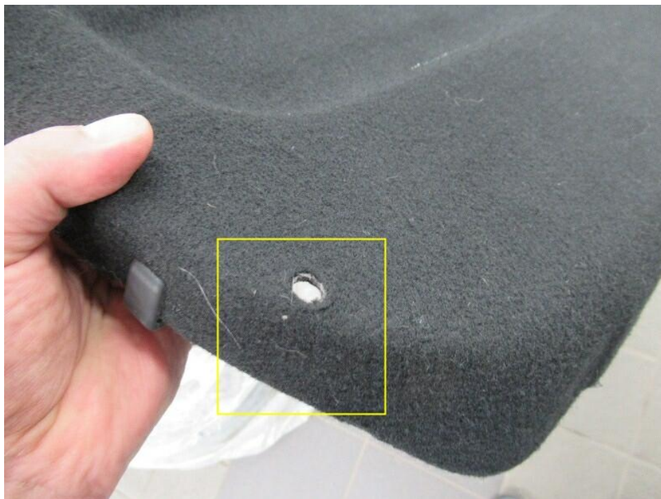
Bild 15 : Verkleidung Laderaum, Halterungen gebrochen, Befestigung links nicht vorhanden
