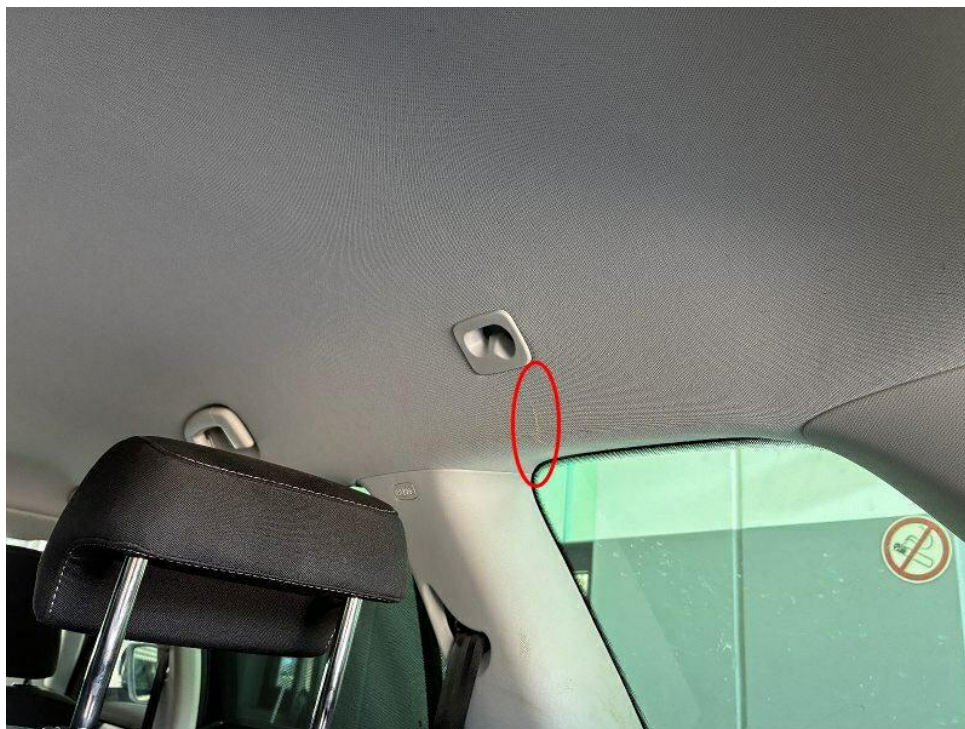
Bild 37 : Dachhimmel, zerkratzt, Gebrauchsspur
