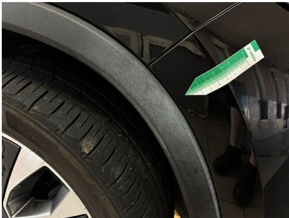
Bild 20 : Radlaufverbreiterung vorne rechts beschädigt
