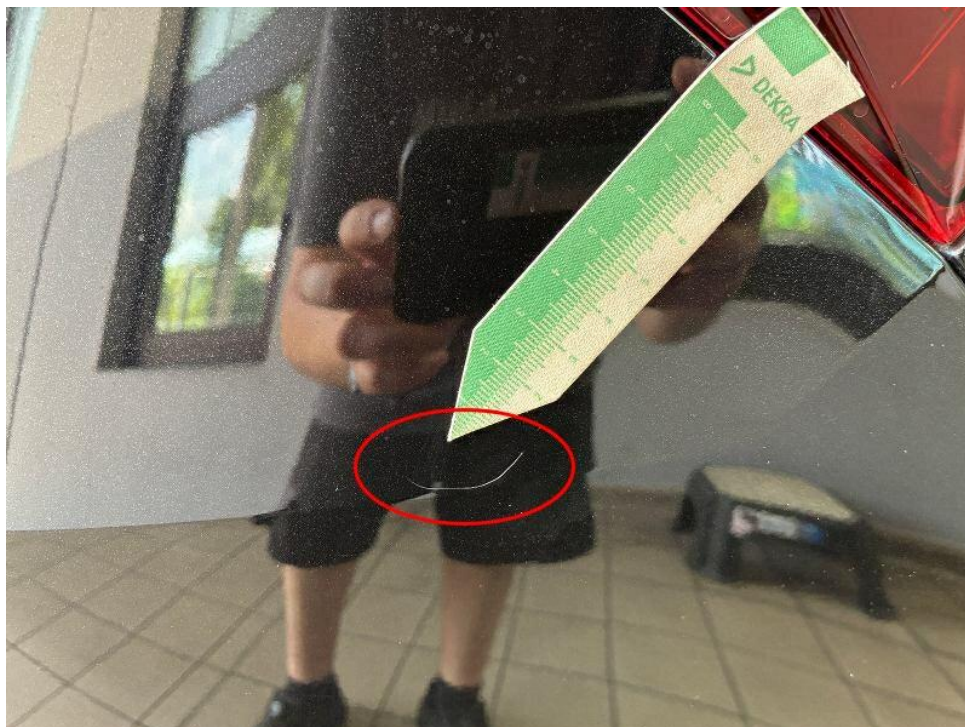
Bild 30 : Stoßfänger hinten Lackierung, zerkratzt, lackieren mit Lackaufbau
