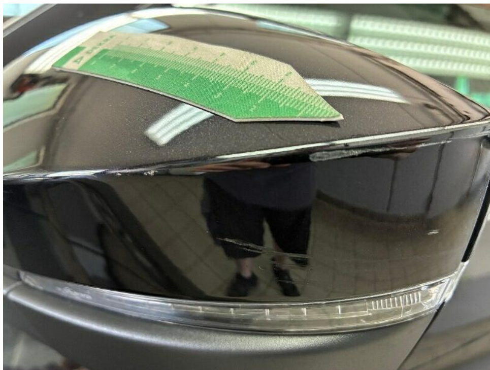
Bild 33 : Außenspiegel links Lackierung, zerkratzt, lackieren mit Lackaufbau
