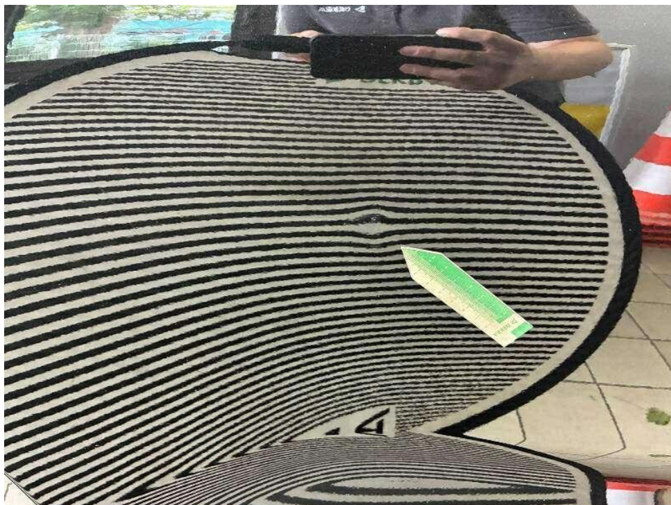
Bild 22 : Tür hinten rechts, eingedellt, instandsetzen und lackieren mit Lackaufbau
