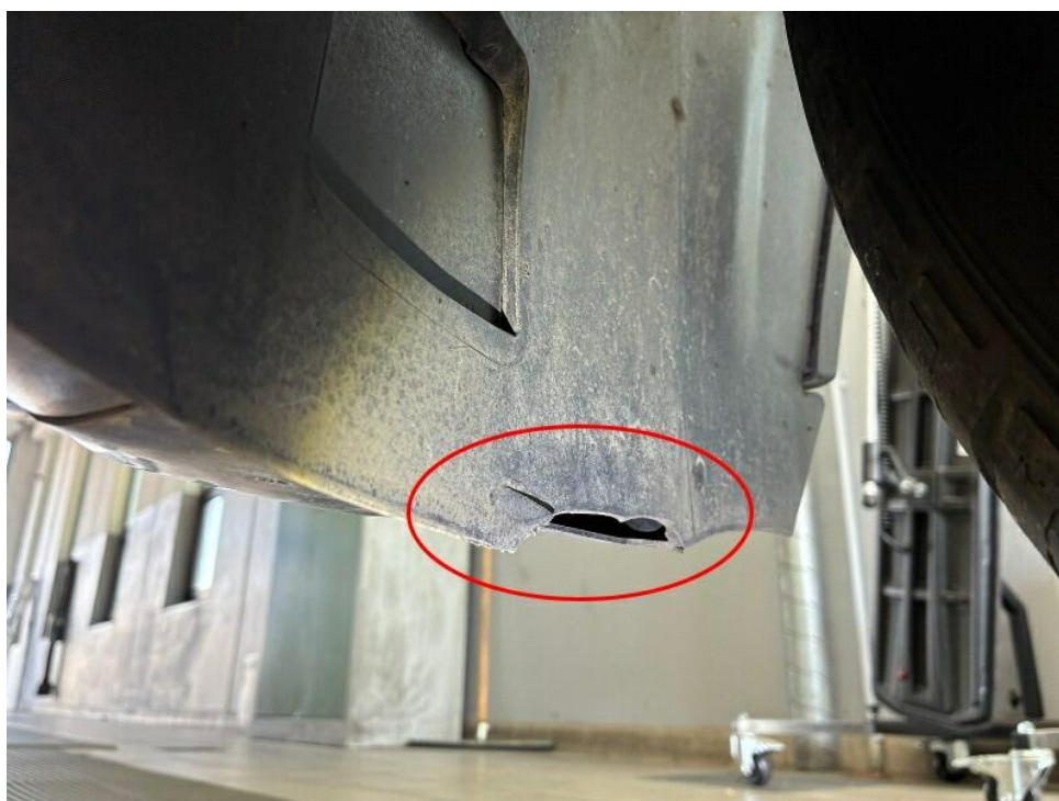
Bild 16 : Radhausschale vorne rechts gebrochen
