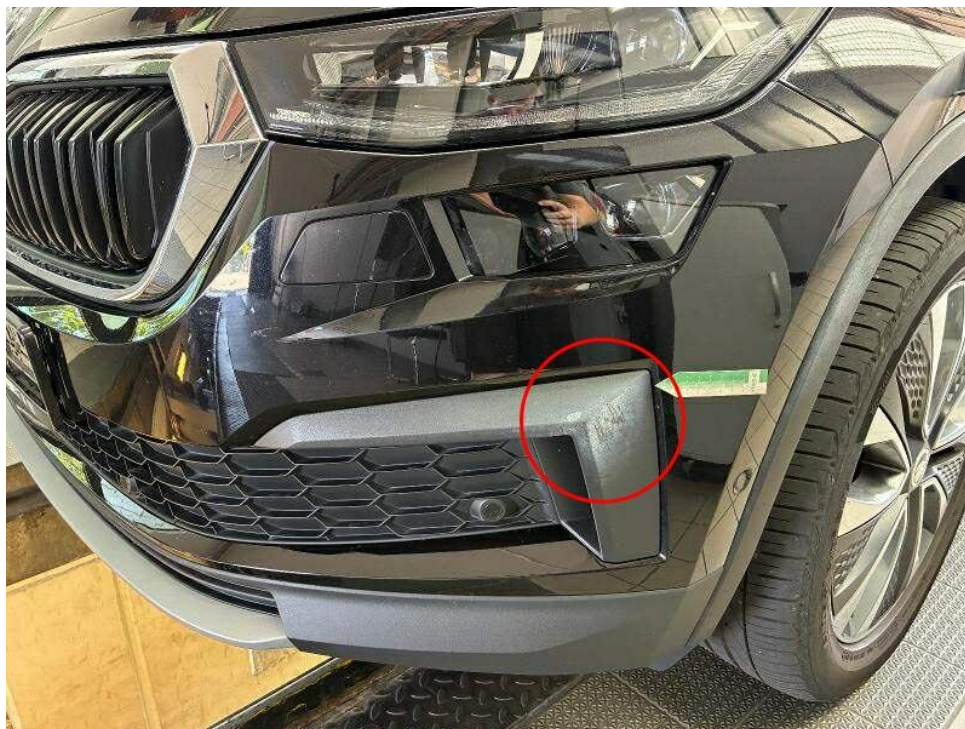
Bild 17 : Stoßfänger Kunststoff Zierleiste vorne links beschädigt
