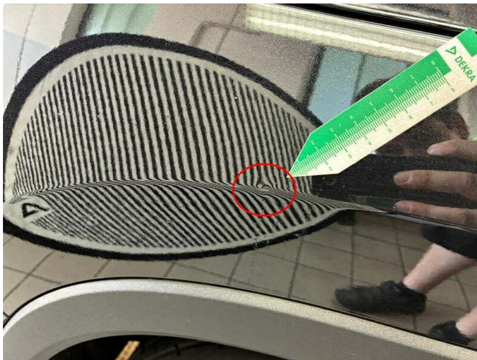
Bild 25 : Seitenteil hinten rechts, eingedellt, instandsetzen und lackieren mit Lackaufbau
