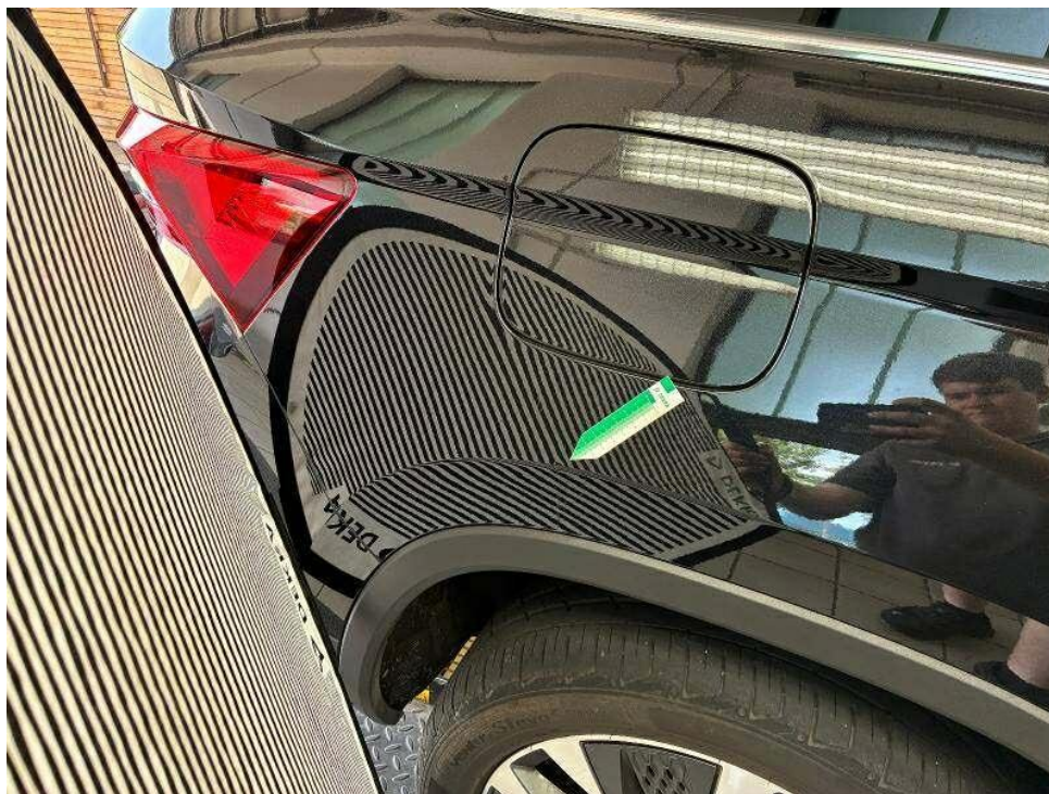
Bild 24 : Seitenteil hinten rechts, eingedellt, instandsetzen und lackieren mit Lackaufbau
