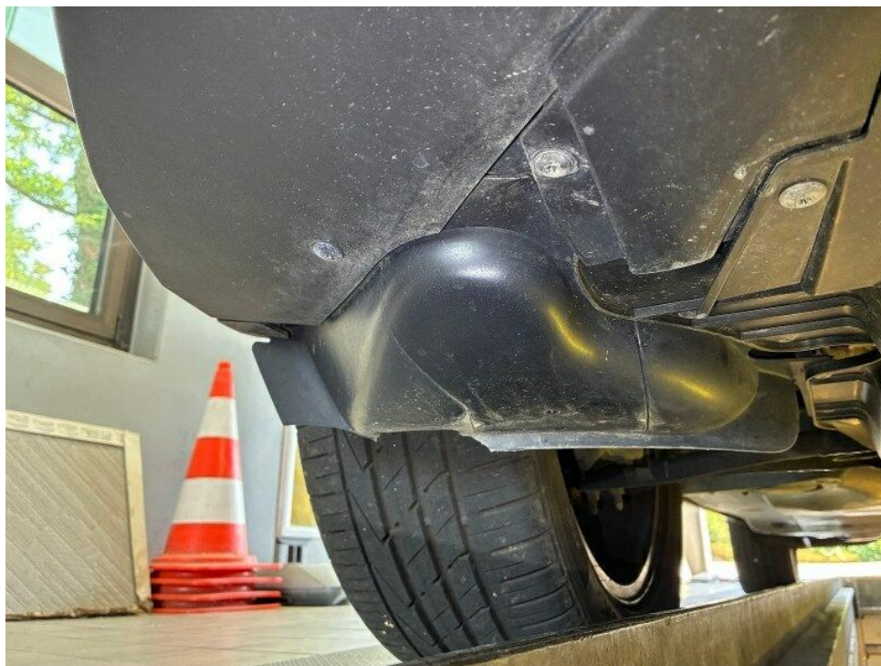
Bild 15 : Radhausschale vorne rechts gebrochen
