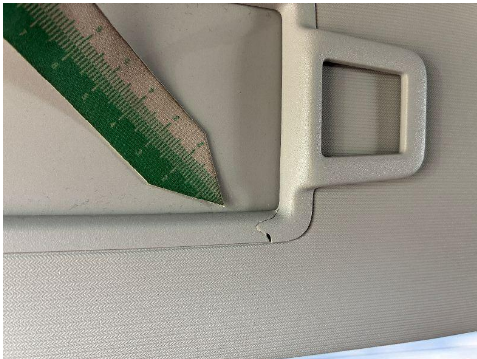
Bild 14 : Sonnenblende links Rahmen gebrochen
