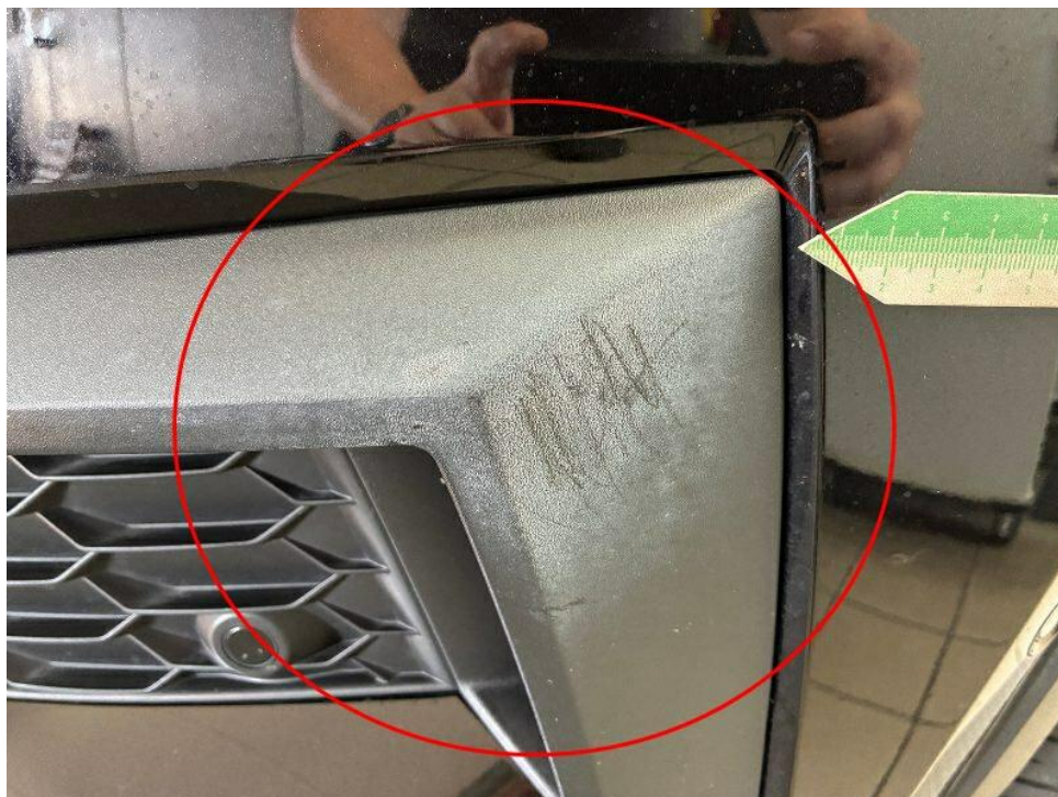
Bild 18 : Stoßfänger Kunststoff Zierleiste vorne links beschädigt
