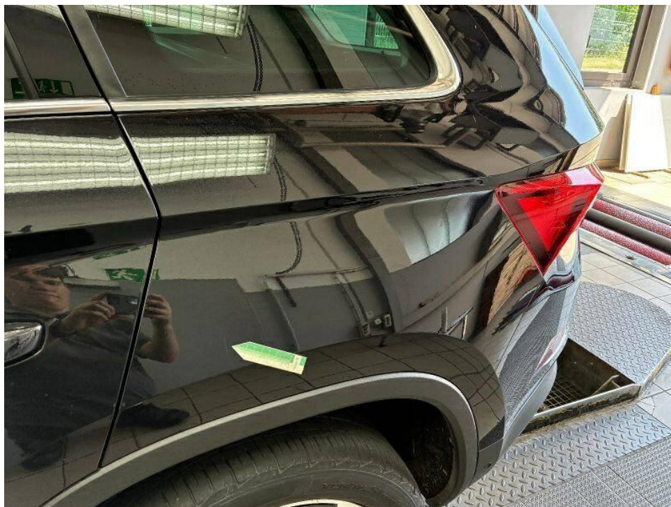
Bild 31 : Seitenteil hinten links Lackierung, zerkratzt, Gebrauchsspur
