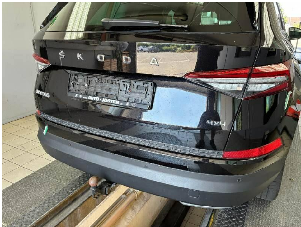
Bild 27 : Stoßfänger hinten Lackierung, zerkratzt, lackieren mit Lackaufbau
