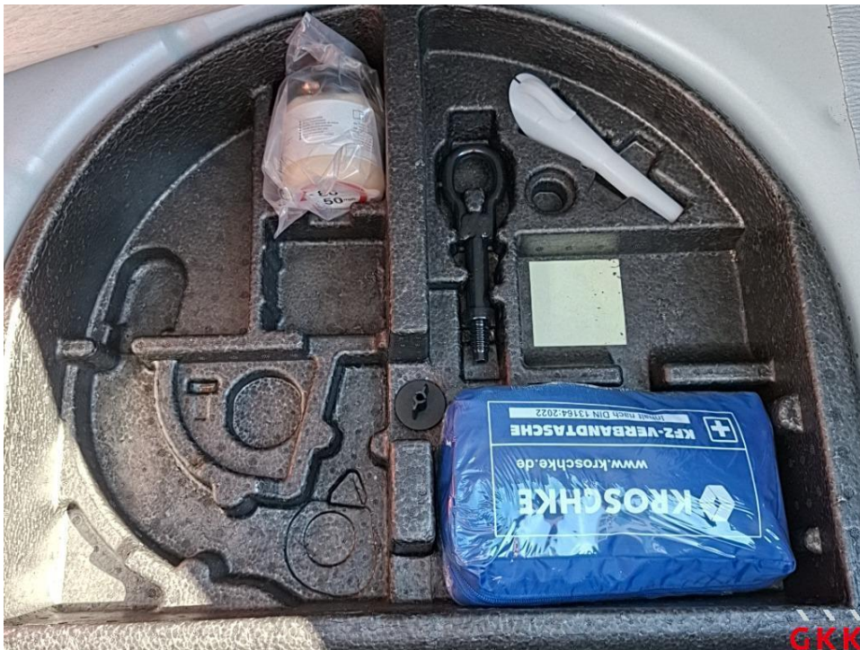
Bild 14 Reifenreparaturset, Füllkompressor, fehlt, ersetzen
