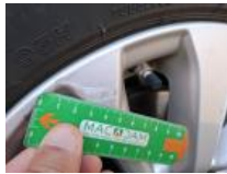
Alloy rim FR, Scratch(es), Repair/replace (lump sum)
