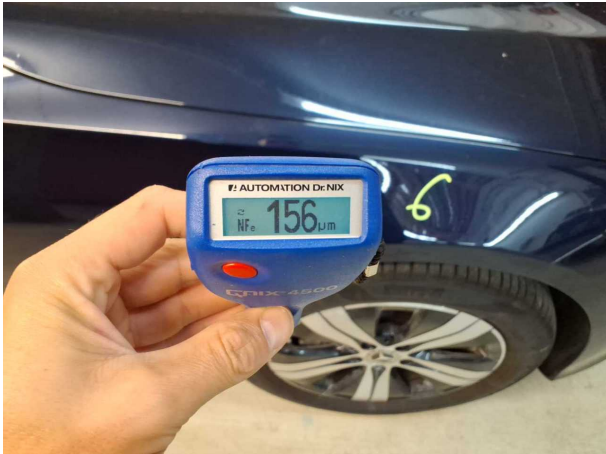
Nachlackierung 1: Kotflügel rechts, Seitenwand rechts, Tür hinten rechts, Tür vorne rechts
