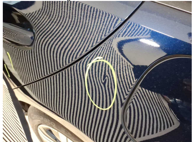
Beschädigung #4: Seitenwand links: Seitenwand - Delle(n) - sanft instandsetzen
