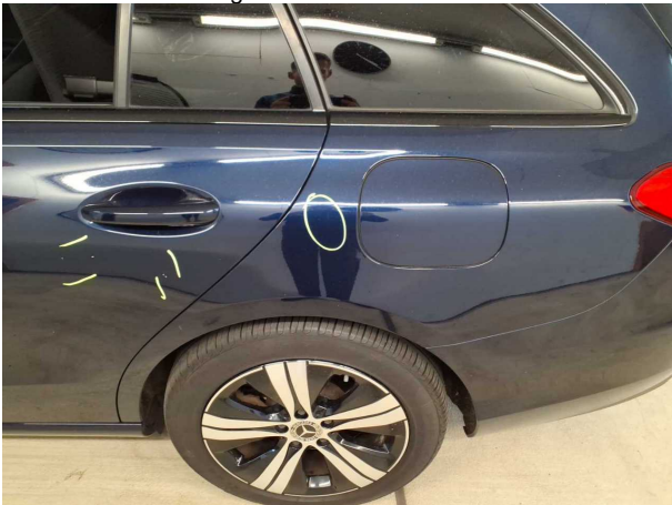
Beschädigung #4: Seitenwand links: Seitenwand - Delle(n) - sanft instandsetzen
