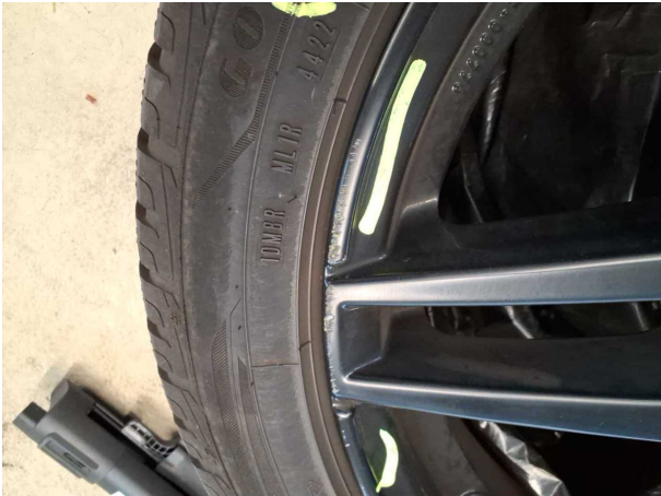
Beschädigung #3: 2.Radsatz: 2 Leichtmetallfelgen - verkratzt / verschürft - kein Abzug
