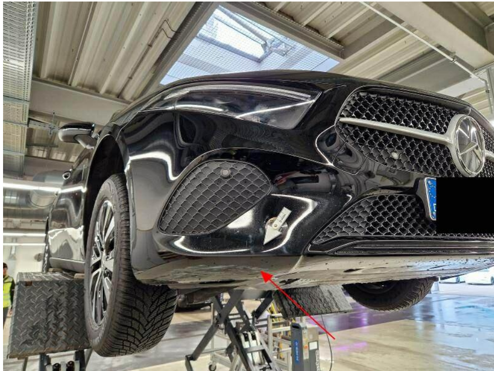
Bild 13 : Stoßfänger vorne verschrammt
