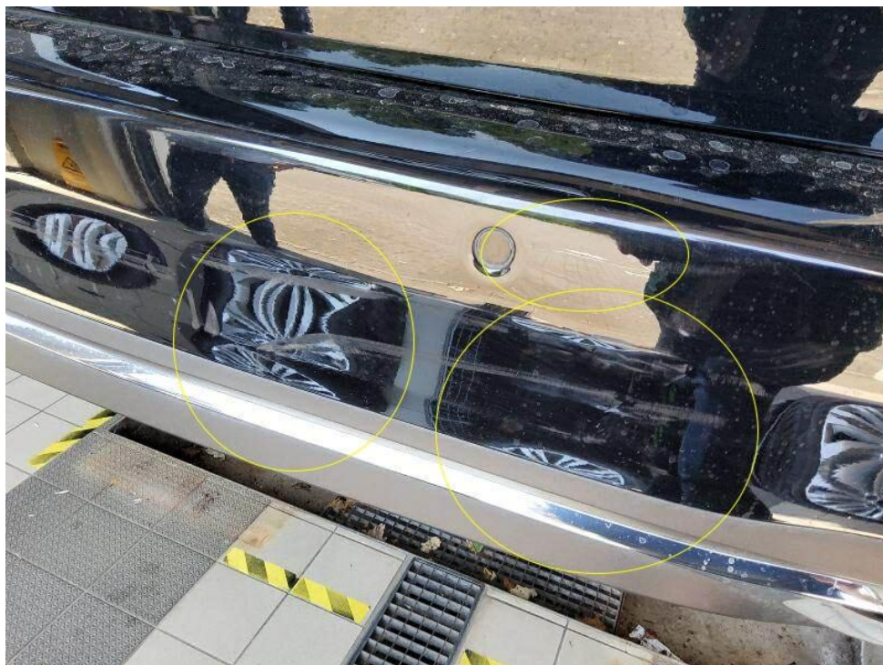
Bild 18 : Heckstoßfängerverkleidung rechts verschrammt und gebrochen - Unfallschaden
