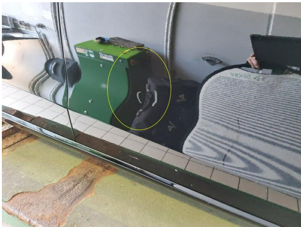
Bild 14 : Tür vorne rechts zwei tiefere Dellen mit Lackbeschädigung - Drücken und lackieren
