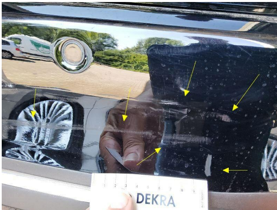
Bild 20 : Heckstoßfängerverkleidung rechts verschrammt und gebrochen - Unfallschaden
