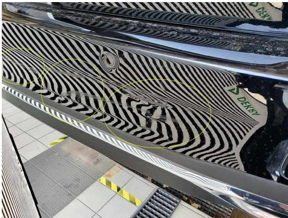
Bild 22 : Heckstoßfängerverkleidung rechts verschrammt und gebrochen - Unfallschaden
