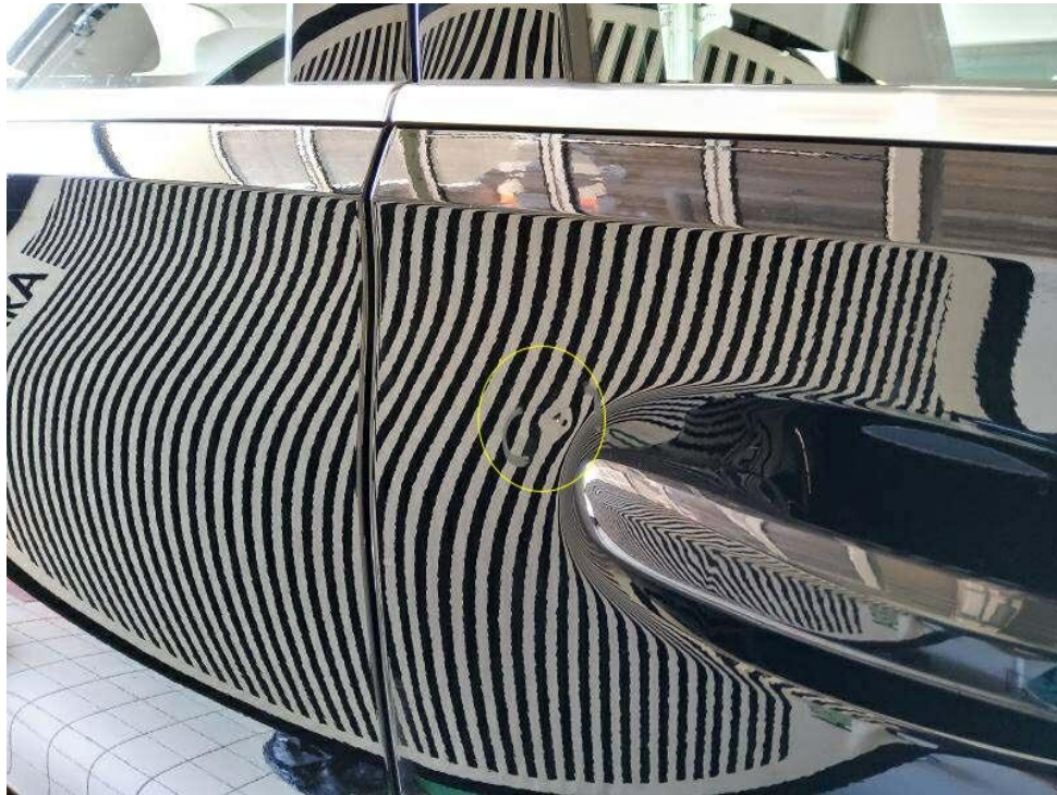
Bild 17 : Tür vorne rechts zwei tiefere Dellen mit Lackbeschädigung - Drücken und lackieren
