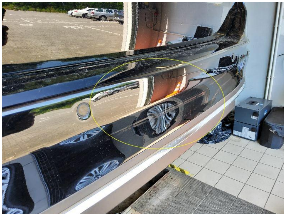
Bild 19 : Heckstoßfängerverkleidung rechts verschrammt und gebrochen - Unfallschaden
