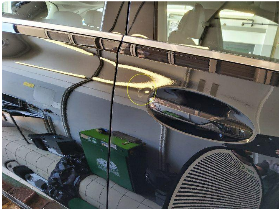
Bild 16 : Tür vorne rechts zwei tiefere Dellen mit Lackbeschädigung - Drücken und lackieren
