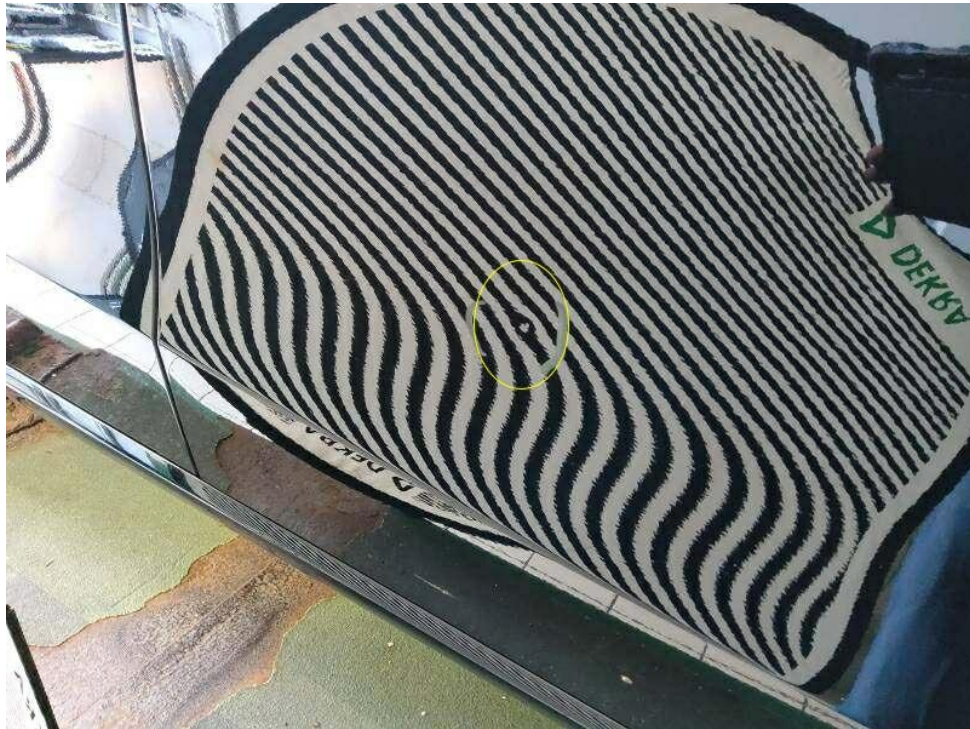
Bild 15 : Tür vorne rechts zwei tiefere Dellen mit Lackbeschädigung - Drücken und lackieren
