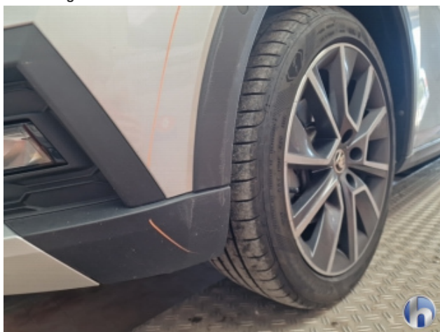
5. Radausschnitt Abdeckungen Beschädigt - Erneuern
