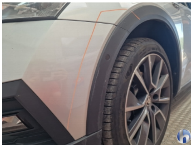
5. Radausschnitt Abdeckungen Beschädigt - Erneuern
