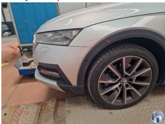
5. Radausschnitt Abdeckungen Beschädigt - Erneuern
