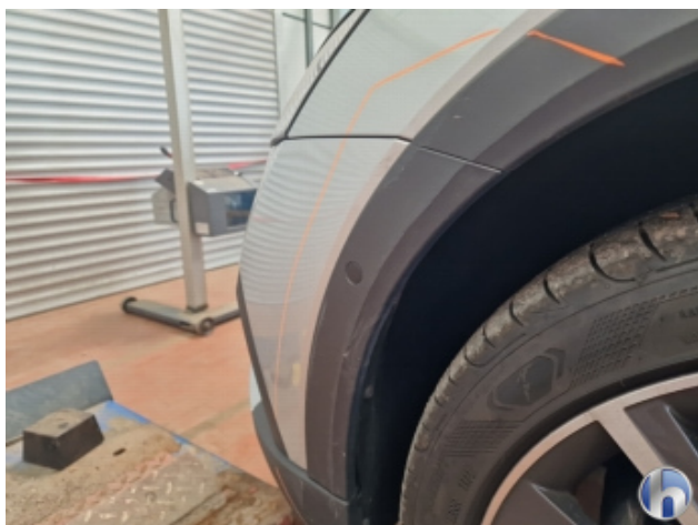
5. Radausschnitt Abdeckungen Beschädigt - Erneuern
