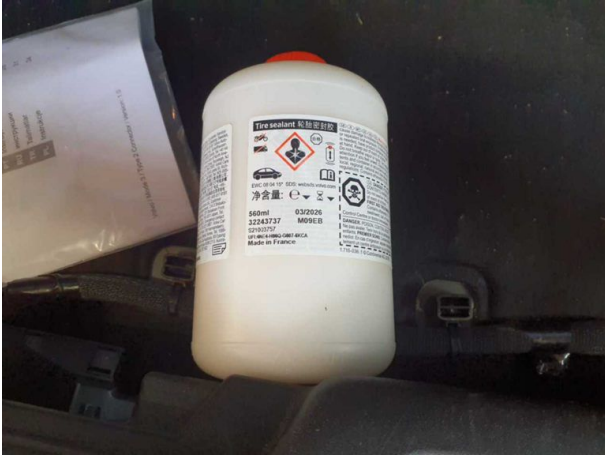
Beschädigung #1: Ausrüstung: Tirefit Füllmittel - abgelaufen - erneuern
