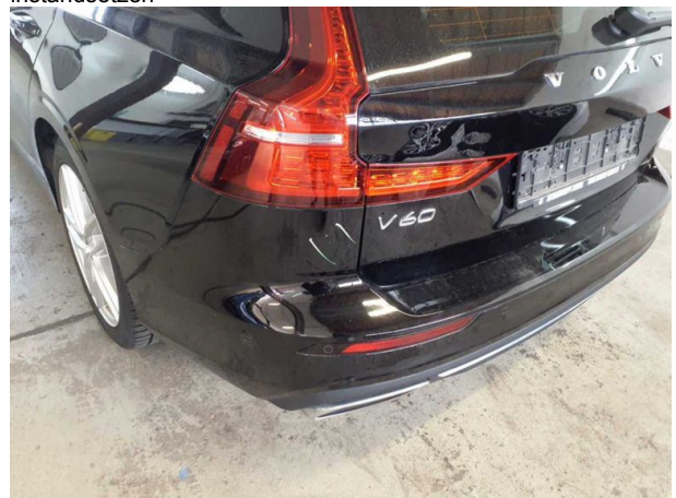
Beschädigung #4: Stossfänger hinten: Stossfänger hinten - verkratzt / verschürft - Smart Repair
