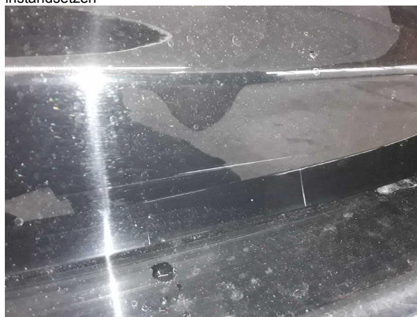
Beschädigung #4: Heckklappe/-tür: Heckklappe - verkratzt / verschürft - Smart Repair
