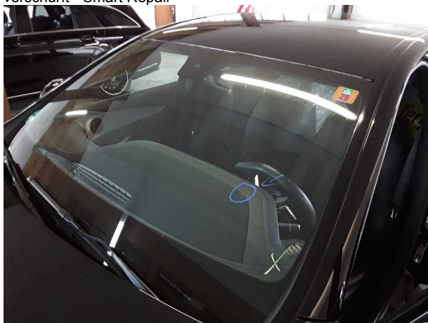
Beschädigung #7: Verglasung: Frontscheibe (Rissbildung) - Steinschlag - erneuern
