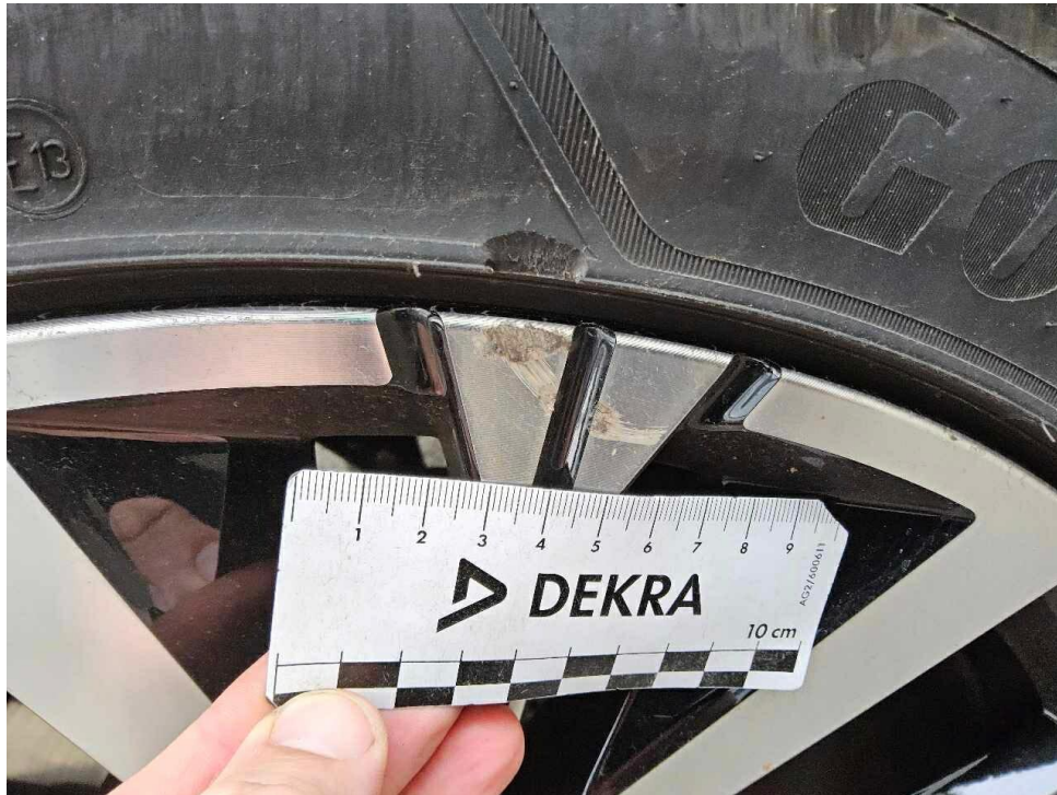
Bild 11 : Felge hinten rechts verkratzt (glanzgedreht) Reifen hinten rechts beschädigt
