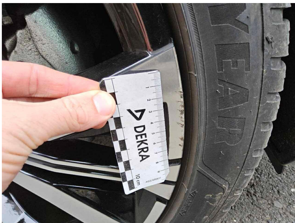
Bild 10 : Felge vorne rechts verkratzt (glanzgedreht)
