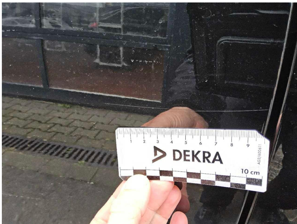
Bild 12 : Tür hinten rechts Lackierung, zerkratzt, lackieren
